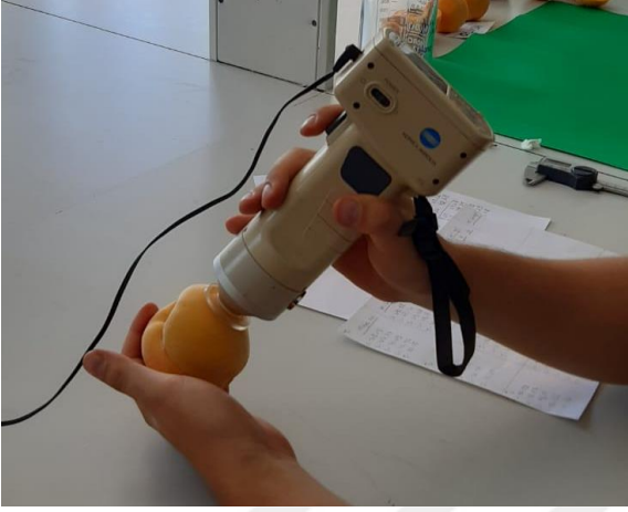
Şekil 24. Meyve kabuk rengi ölçümü (Orijinal fotoğraf F. F. Cankı, 2023)
