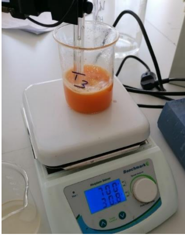
Şekil 26. Meyve titre edilebilir asitlik ölçümü (Orijinal fotoğraf F. F. Cankı, 2023)
