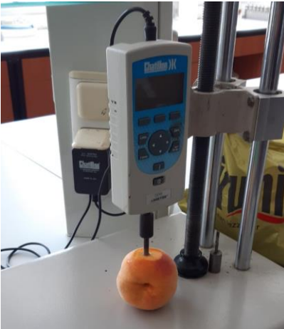
Şekil 25. Meyve sertliği ölçümü (Orijinal fotoğraf F. F. Cankı, 2023)
