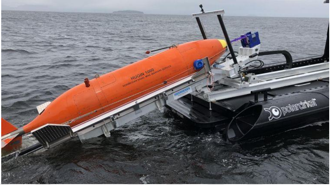
Şekil 1.5 : Kongsberg firmasına ait auv atma-toplama operasyonu (This Is How an Unmanned Launch and Recovery System Operates | Hydro International, t.y.).
