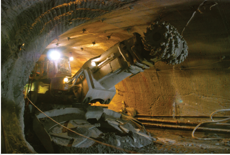
Şekil 2.3 Kollu galeri açma makinesi (Anonymous 2, 2023)
