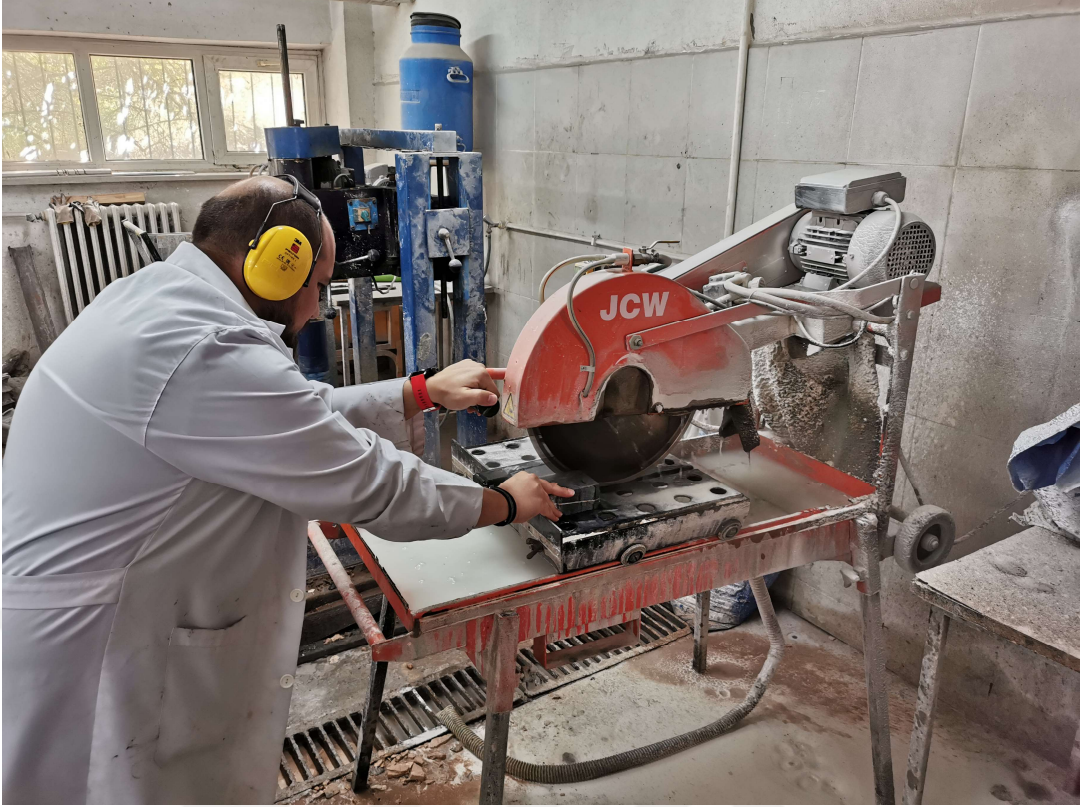
Şekil 3.23. Siever's minyatür delme deneyi için numunelerin hazırlanması
