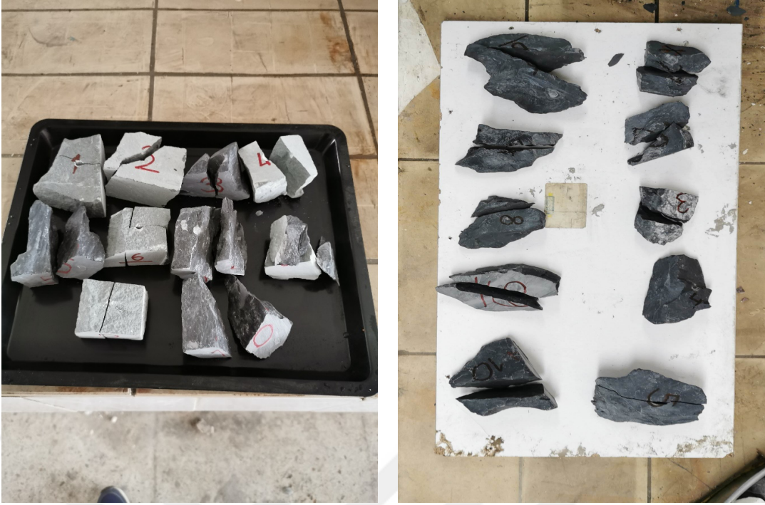
Şekil 3.20. Nokta yükleme dayanımı deneyinde kullanılan bazı numunelerin deney sonrası görüntüleri
