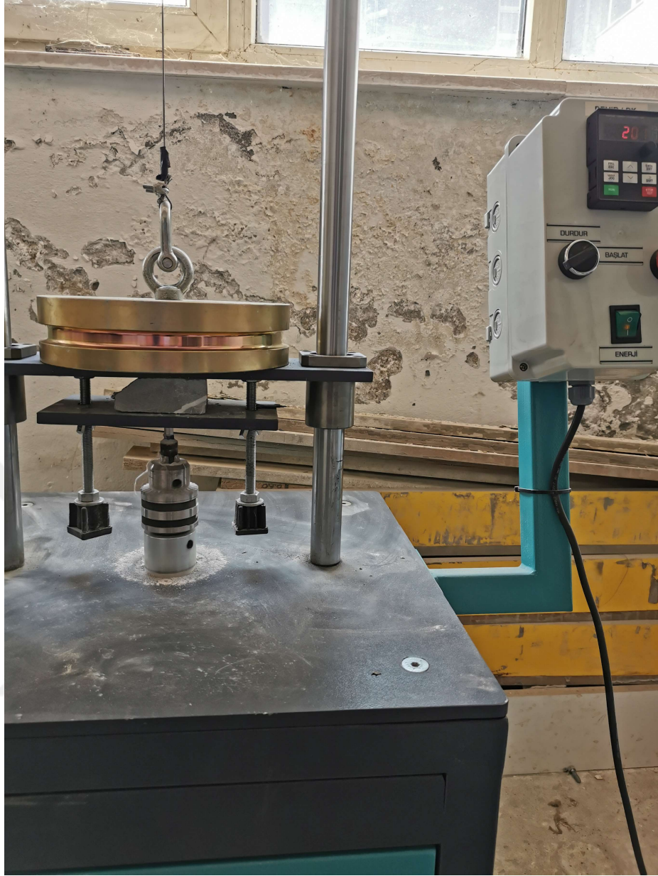
Şekil 3.24. Siever's minyatür delme cihazı ve deneyin gerçekleştirilmesi
