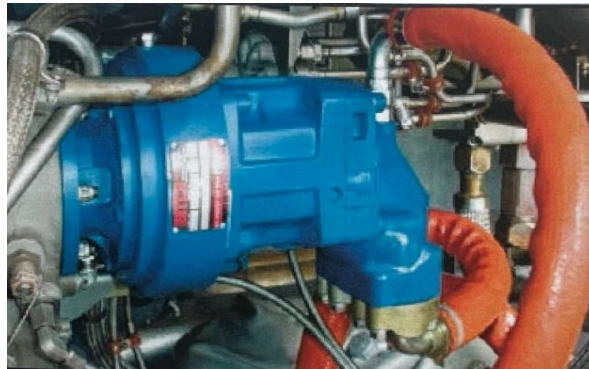
Şekil 5.21. Hidrolik starter (Kurban, 2019a)
