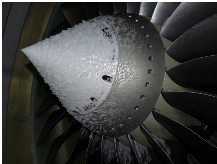
Şekil 3.7. Motor girişinde oluşan buzlanma örneği (Şal, 2021)
