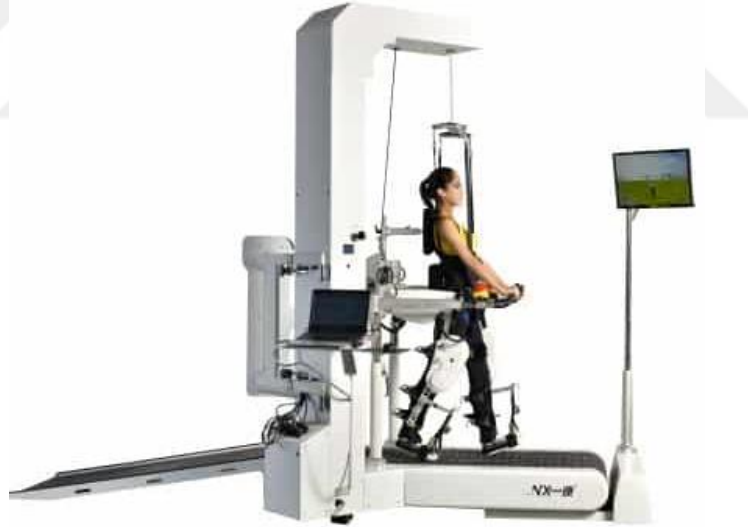
Şekil 7. Yürüyüş Bandı Temelli Ekzoskeleton Tipi Robotik Cihaz (Lokomat®)
