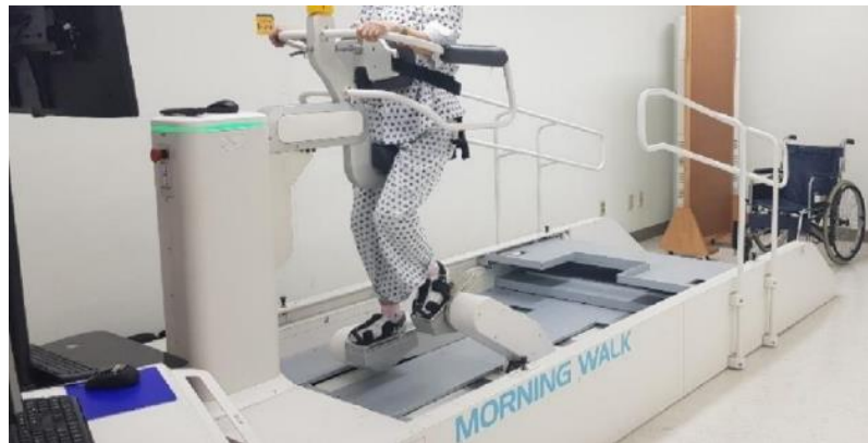
Şekil 6. End-efektör Sistem Robotik Cihaz
