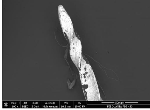
Şekil 47: AH Plus kanal patı ile doldurulmuş kanalın sökümünde kullanılan Twisted File Adaptive eğesi en uç noktası x100 SEM görüntüsü
