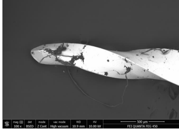
Şekil 26: Kontrol Grubu ProTaper Universal Retreatment D1 eğesi en uç noktası x100
