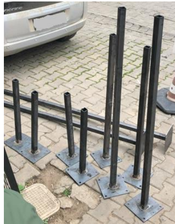
Şekil 3.14. Profiller ile lamaların birleştirilmesi
