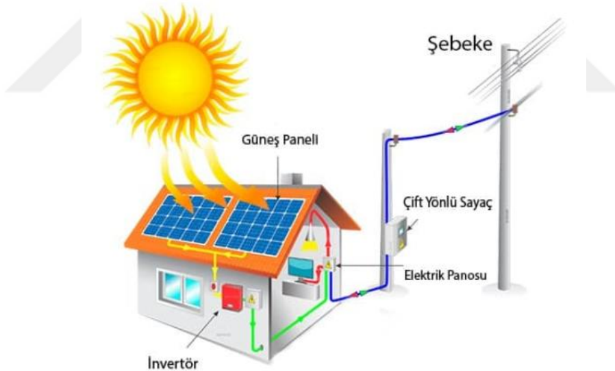
Şekil 2.21. Şebekeye bağlı fotovoltaik sistem yapısı (Aden solar, 2021)
