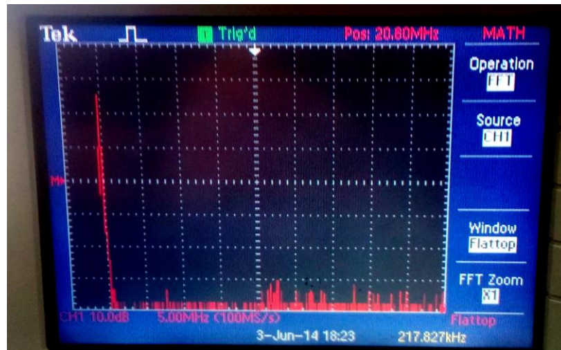
Şekil 6.49. C = 10\text{pF} ile QO için çıkış spektrumu
