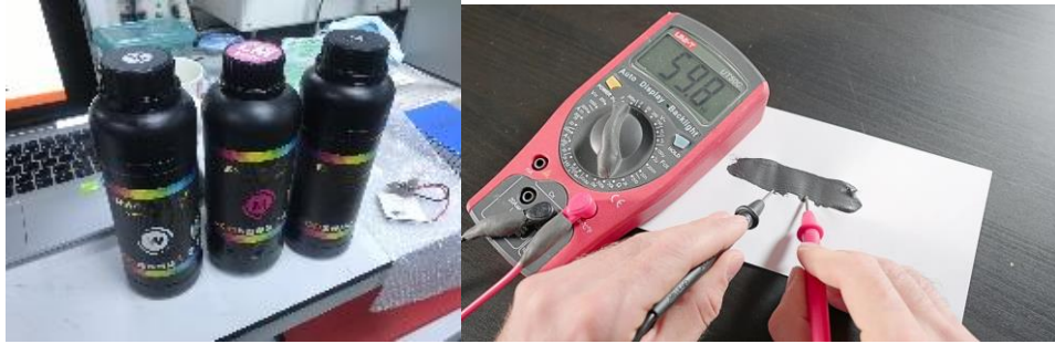
Şekil 3.5: Rıcoh marka UV led küreme boyası iletkenlik testi
