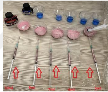
Şekil 3.28: Farklı su yoğunluklarına sahip karışımların görseli.
