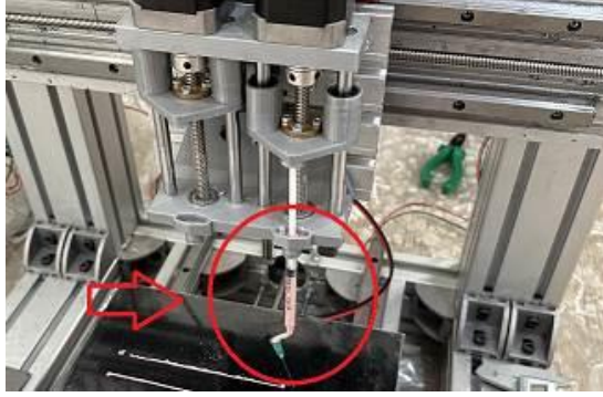
Şekil 3.25: Düşük akışkan ile akıtma sırasında yaşanan iğnenin enjektör başından çıkması durumunun görseli.
