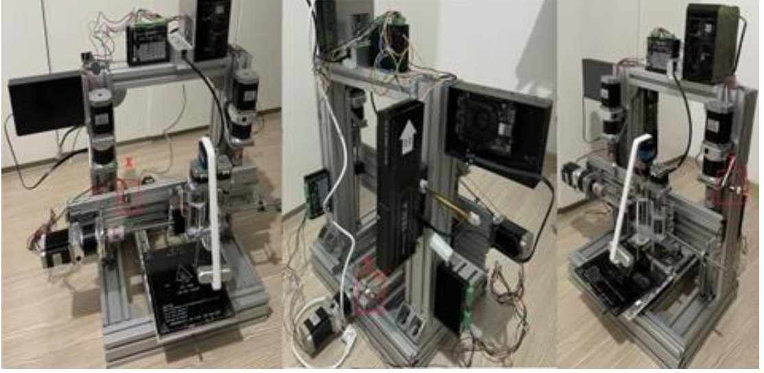
Şekil 3.11: Sıfırlama anahtarlarının bulunduğu konumlar.
