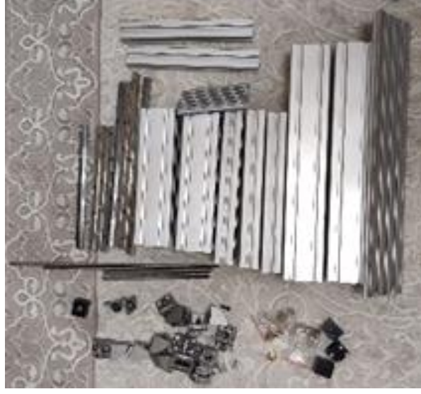
Şekil 3.7: Üç boyutlu yazıcıyı oluşturan profiller ve bağlantı bileşenleri görseli
