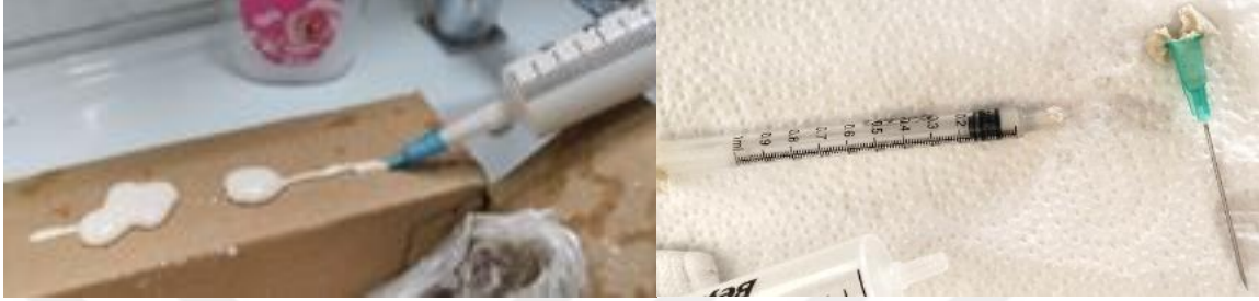
Şekil 3.6: Üç farklı enjektör görseli, baskı sırasında patlamalı akış ve enjektör tıkanması görselleri
