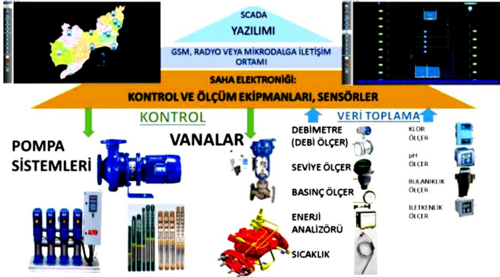
Şekil 6.2: İçme suyu SCADA'sı (Başa ve Kurt, 2017)
