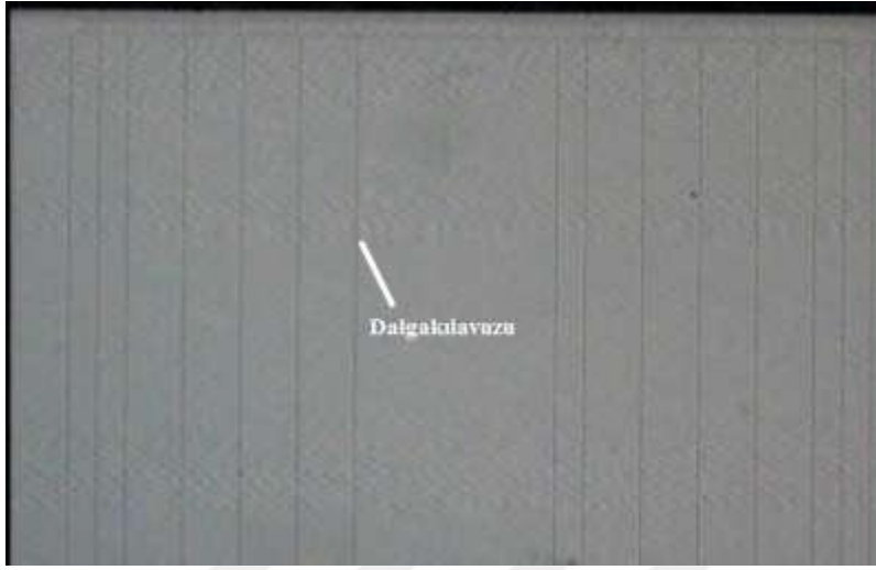
Şekil 3.25. Ti difüzyonlu dalga kılavuzu yapısı
