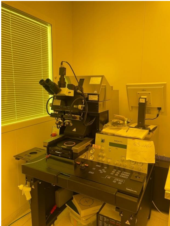
Şekil 3.18. Maske ve alttaş kopyalama cihazı
