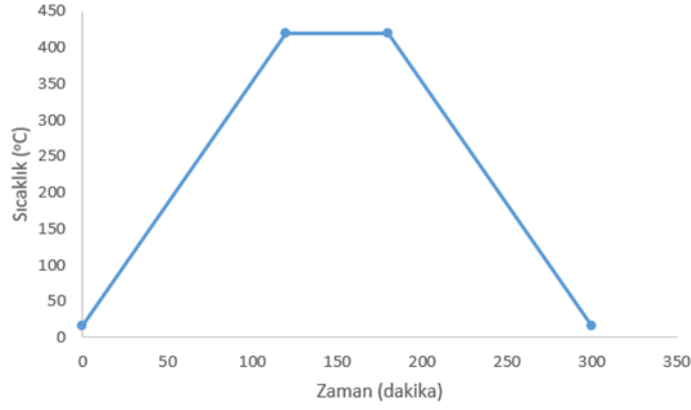
Şekil 3.13 : Bağlayıcı giderme işleminin aşamaları.
