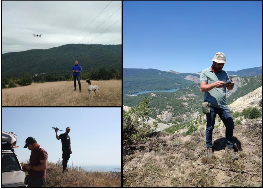
Fotoğraf 3. İHA ile veri toplama işlemleri (DJI Mavic 2 Pro İHA ile Ortofoto ve nokta bulutu üretmek üzere uçuşlar yapılmıştır).
