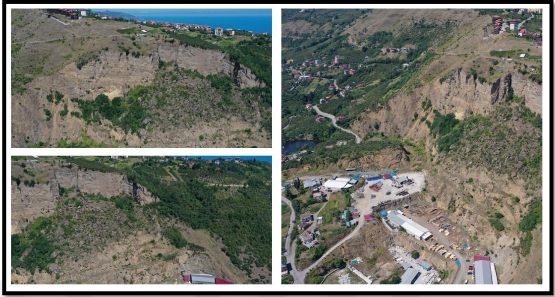
Fotoğraf 23. Sera Gölü'nü oluşturan heyelan kütleleri üzerinde kaya düşme potansiyeline sahip alanlar ve heyelan taç noktası üzerinde yeni heyelan gelişmesi durumunda etkilenmesi olası otel ve yerleşme alanları.
