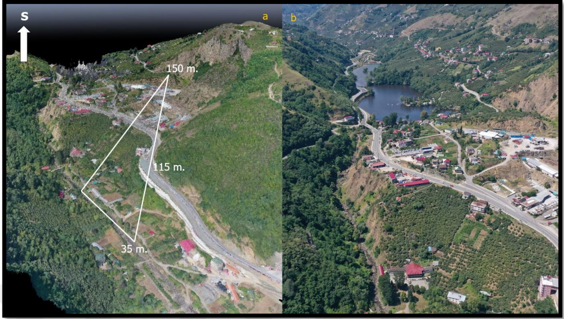
Şekil 78. a) İHA verisi ile üretilen 3B nokta bulutu modelinde alanın gösterimi. b) İHA fotoğrafı ile alanın gösterimi.
