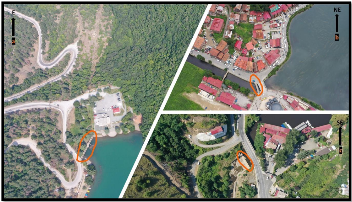
Fotoğraf 1. Heyelan set göllerinde dolu savak inşa edilerek göller kontrol altına alınmaya çalışılmıştır. a) Boraboy, b) Uzungöl, c) Sera Gölü.
