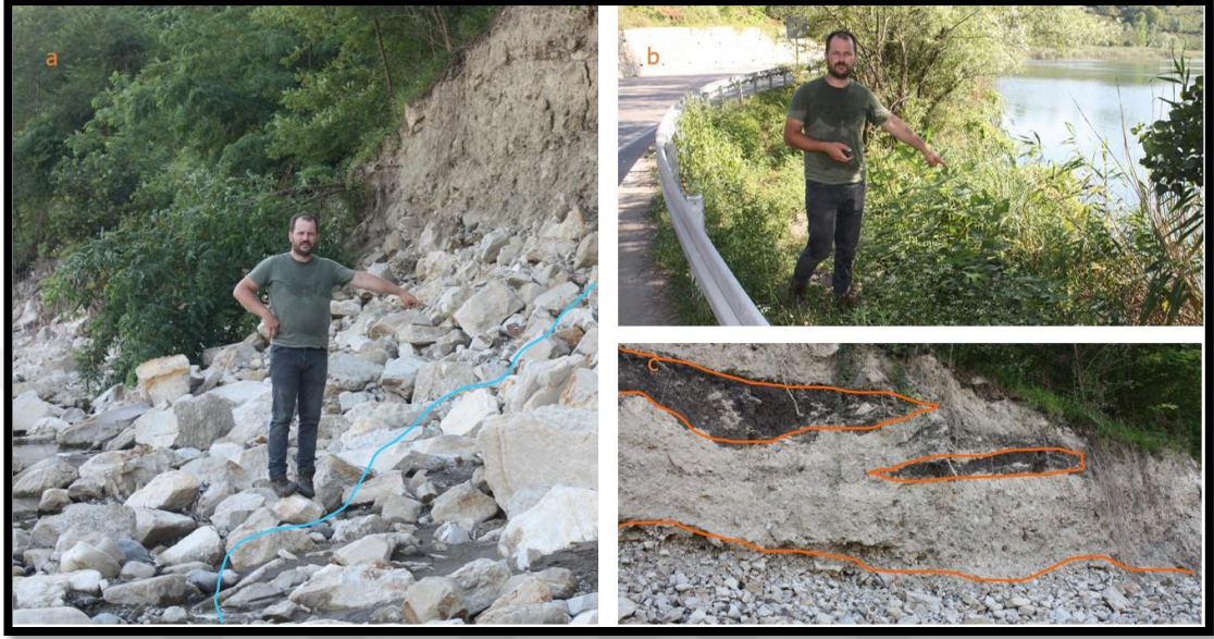
Fotoğraf 18. a) Gaga Gölü'nden sızan suların Bolaman Çayı vadisi içerisinde regolit birimler arasında çıkışı. b) Gaga Gölü ayağının battığı en düşük 70 m kot alanı. c) Heyelan kütleindeki tabaka durumu, en altta parçalanmış regolit birimler, üstte farklı zamanlarda kütle hareketiyle tabaka arasına giren turbalı yapı.
