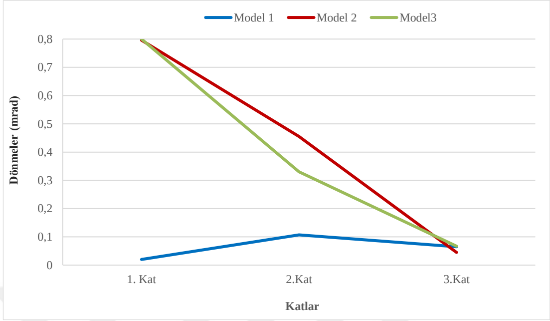
Şekil 4.16. Safran konak modellerinin x doğrultusunda deprem etkisinde yapısal çözümlemesi sonucu katlardaki dönme değerleri.
