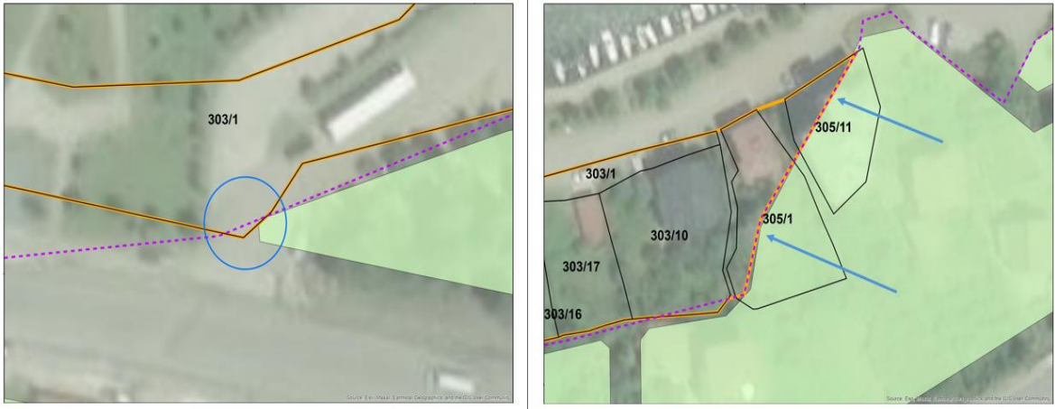
Şekil 14. Kalecik Mahallesi düzenleme sınırı geçirilmesi detayları
