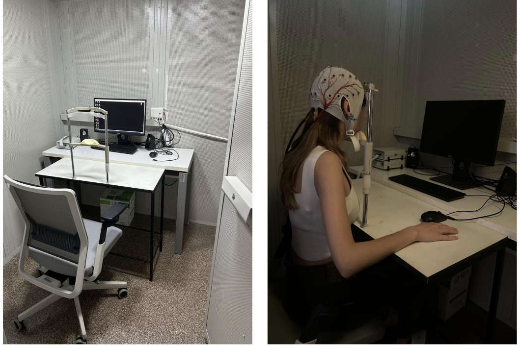
Resim 5.4.1 EEG çekimlerinin gerçekleştirildiği Faraday Kafes ve kayıt esnasında kullanılan çene destekleyici düzenek
