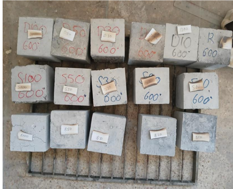
Şekil 3.15. etüvden çıkarılmış beton numuneleri
