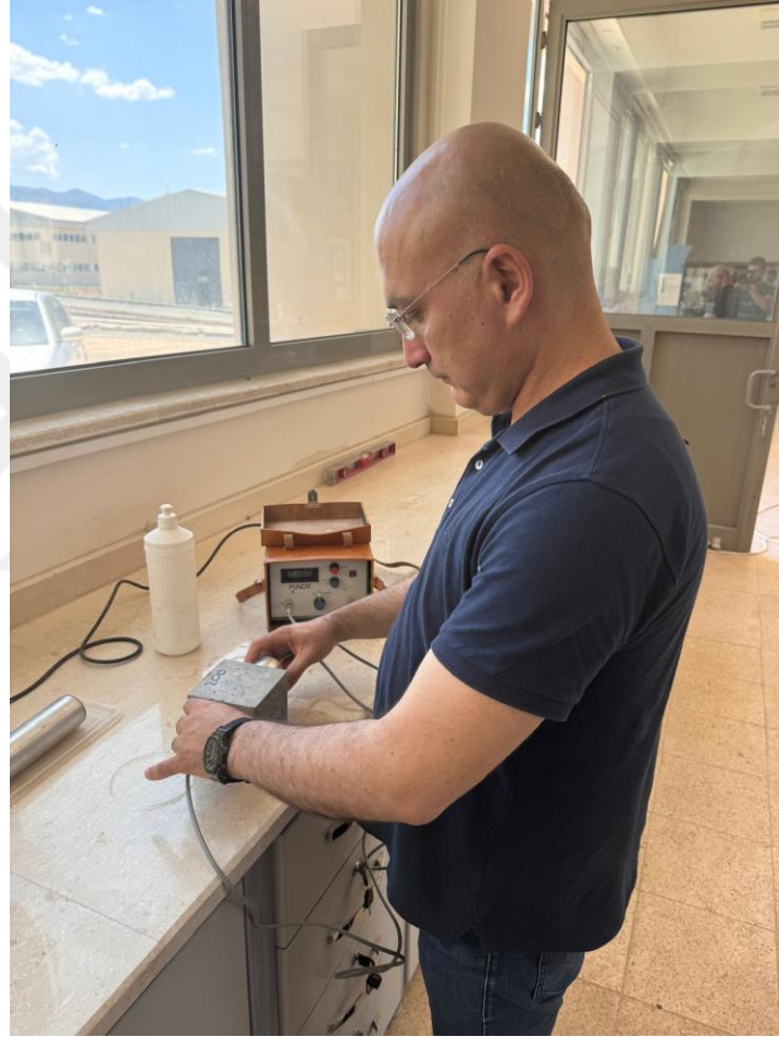
Şekil 3.8. Beton numunelerinin laboratuvarında ultrasonik hız ölçümü ile basınç dayanımı testi
