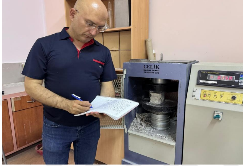
Şekil 3.7. Beton numunelerinin laboratuvarda basınç testine tabi tutulması
