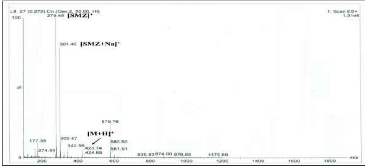
Şekil 4.32. L8 inhibitörünün LC-MS spektrumu
