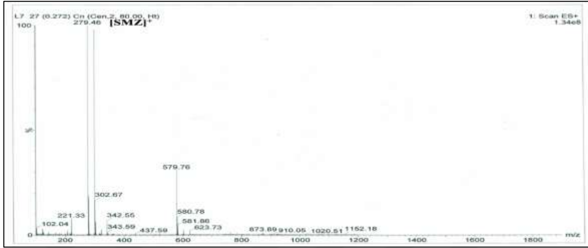
Şekil 4.28. L7 inhibitörünün LC-MS spektrumu
