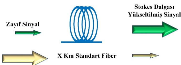
Şekil 3.3. Raman yükseltecin yapısı
