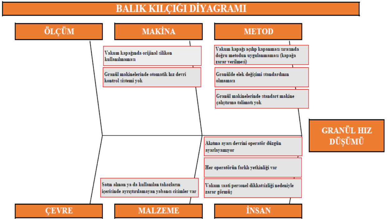
Şekil 4.17. Granül Ekstrüzyon Hattında Balık Kılçığı Diyagramı Uygulaması
