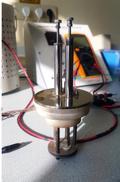
Şekil 3.4. Metal plakalar arasına yerleştirilen dielektrik ölçüm numunesi
