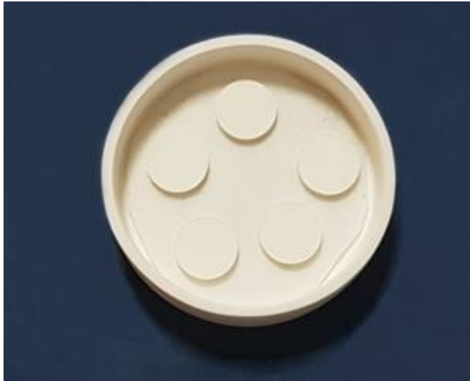
Şekil 3.3. 200 MPa basınç uygulanarak preslenmiş numuneler.
