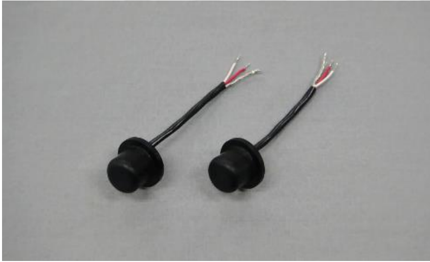
Şekil 2.5. Ultrasonik dalga tespit sensörü [85].
