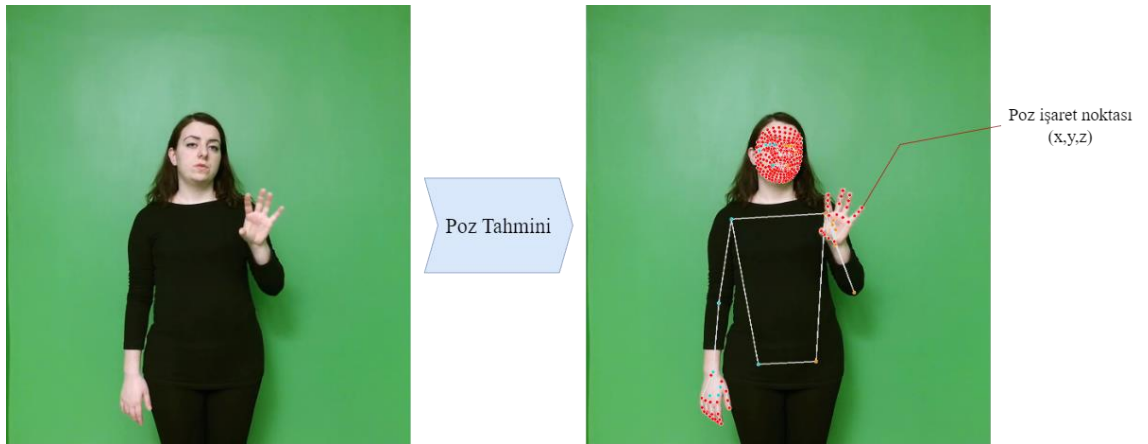
Şekil 3.4. Örnek bir video karesinden poz işaret noktalarının elde edilmesi
