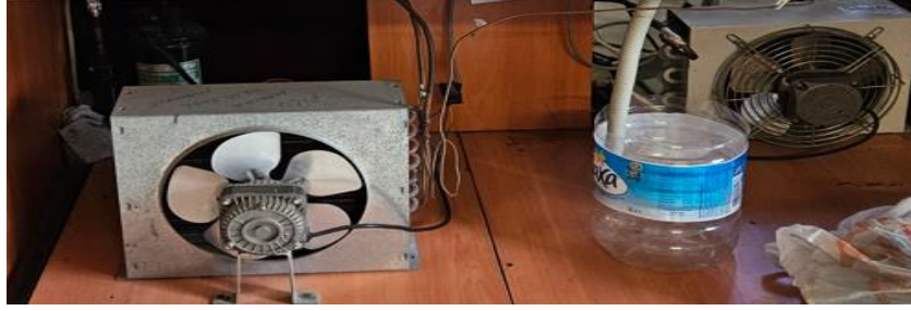
Şekil 4.6 Kurutma sisteminde kullanılan kompresör ve buharlaştırıcı
