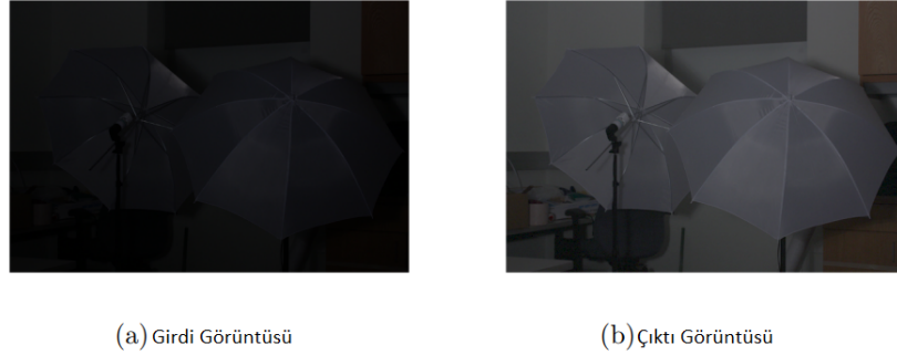
Şekil 2.7 : \gamma = 0,5 için gamma dönüşümünün girişi ve çıkışı
