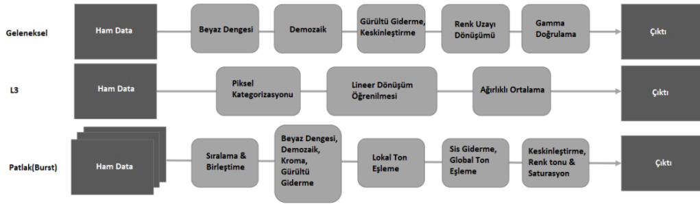
Şekil 4.5 : Yukarıdan aşağıya doğru: geleneksel bir görüntü işleme hattı, L3 veri hattı [1] ve bir patlama(burst) görüntüleme veri hattı [2]
