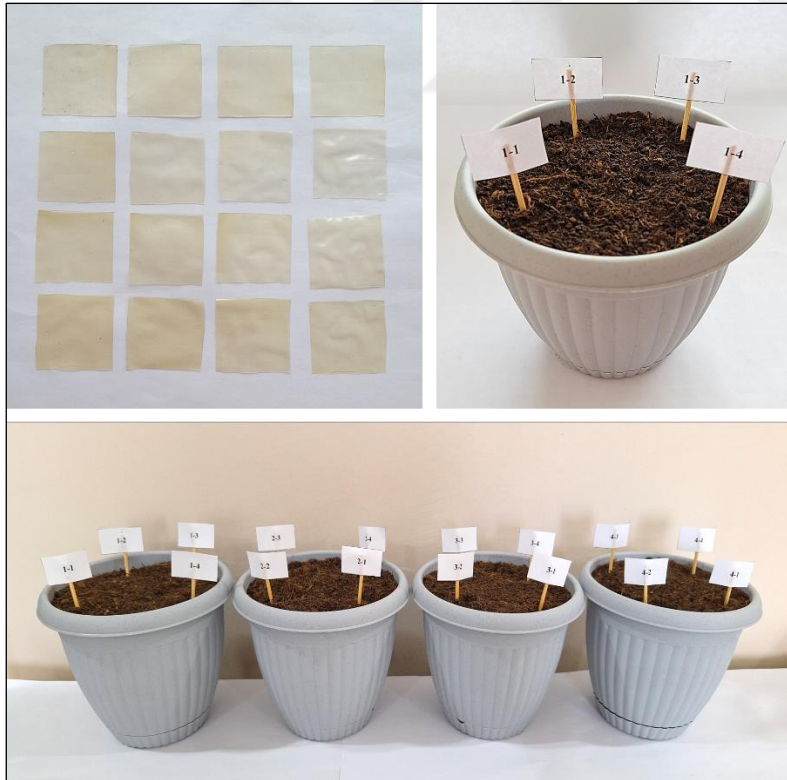
Şekil 3.5. Biyopolimerik filmlerin toprakta parçalanma testi için toprağı gömüldüğü saksılar ve örneklerin yerleşimi
