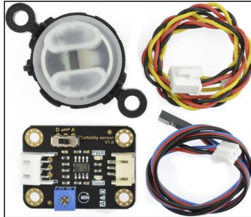
Şekil 3.13. Sistemde kullanılan bulanıklık sensörü
