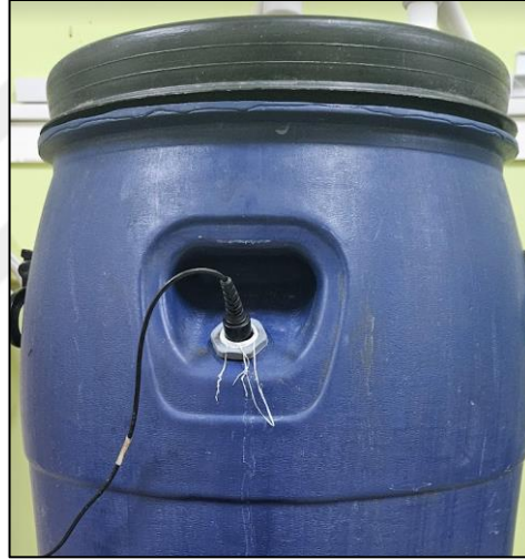
Şekil 3.16. Reaktör üzerine montaj edilmiş çözünmüş oksijen sensörü
