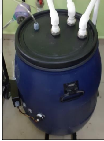
Şekil 3.3. Kompost çayı üretimi için özelleştirilmiş HDPE Tank
