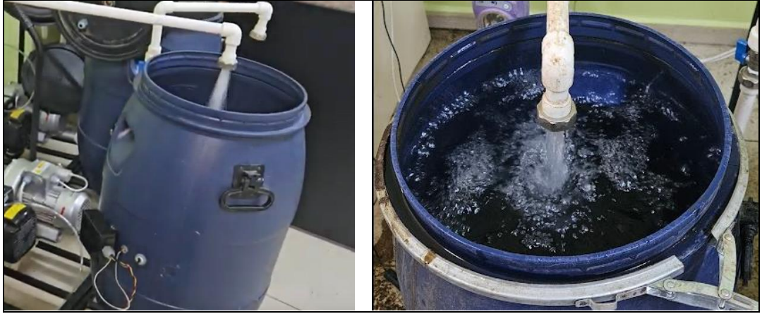
Şekil 3.36. Devirdaim pompası ile yapılmış klordan arındırma işlemi
