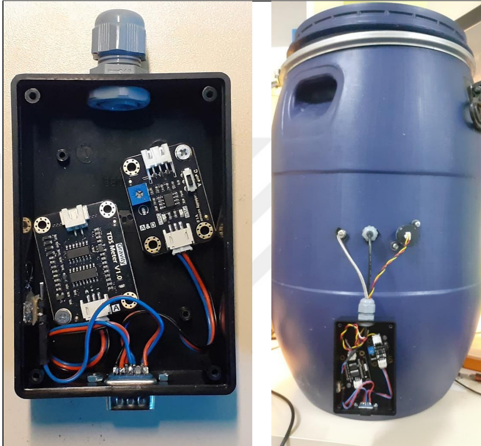
Şekil 3.10. Sensörler ve transdüserlerin yerleşimleri
