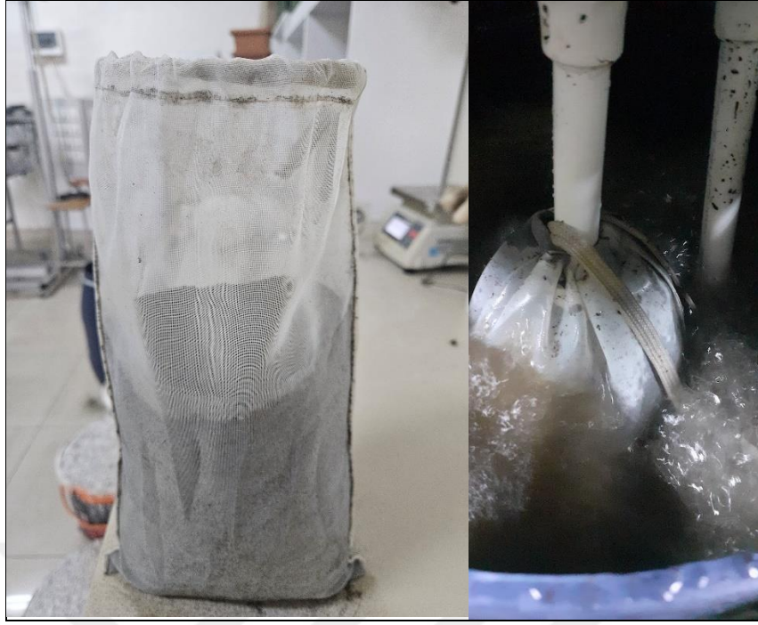
Şekil 3.7. Deneme öncesi ve esnasında kompost materyali doldurulmuş filtre torbası
