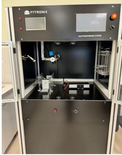
Resim 3.2. Nano fiber üretiminde kullandığımız elektroğirme cihazının görüntüsü
