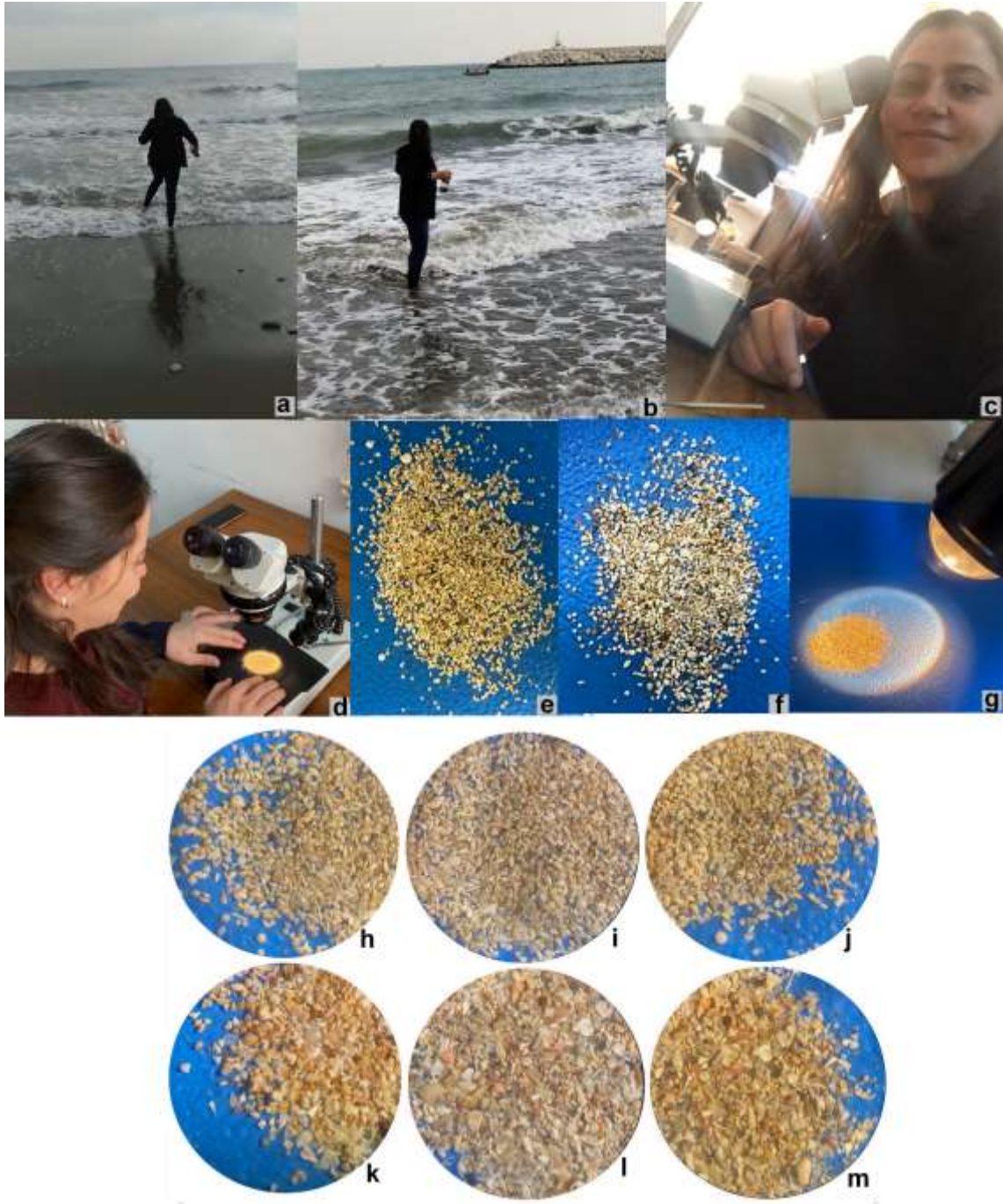
Şekil 2.2. a-b. Çalışma alanında sistematik örnek alma görüntüleri, c-d. Binoküler mikroskop altında bentik foraminiferlerin ayıklanması işlemi e-m. ICP-OES analizi için binoküler mikroskop altında örneklerin hazırlanması işlemi
