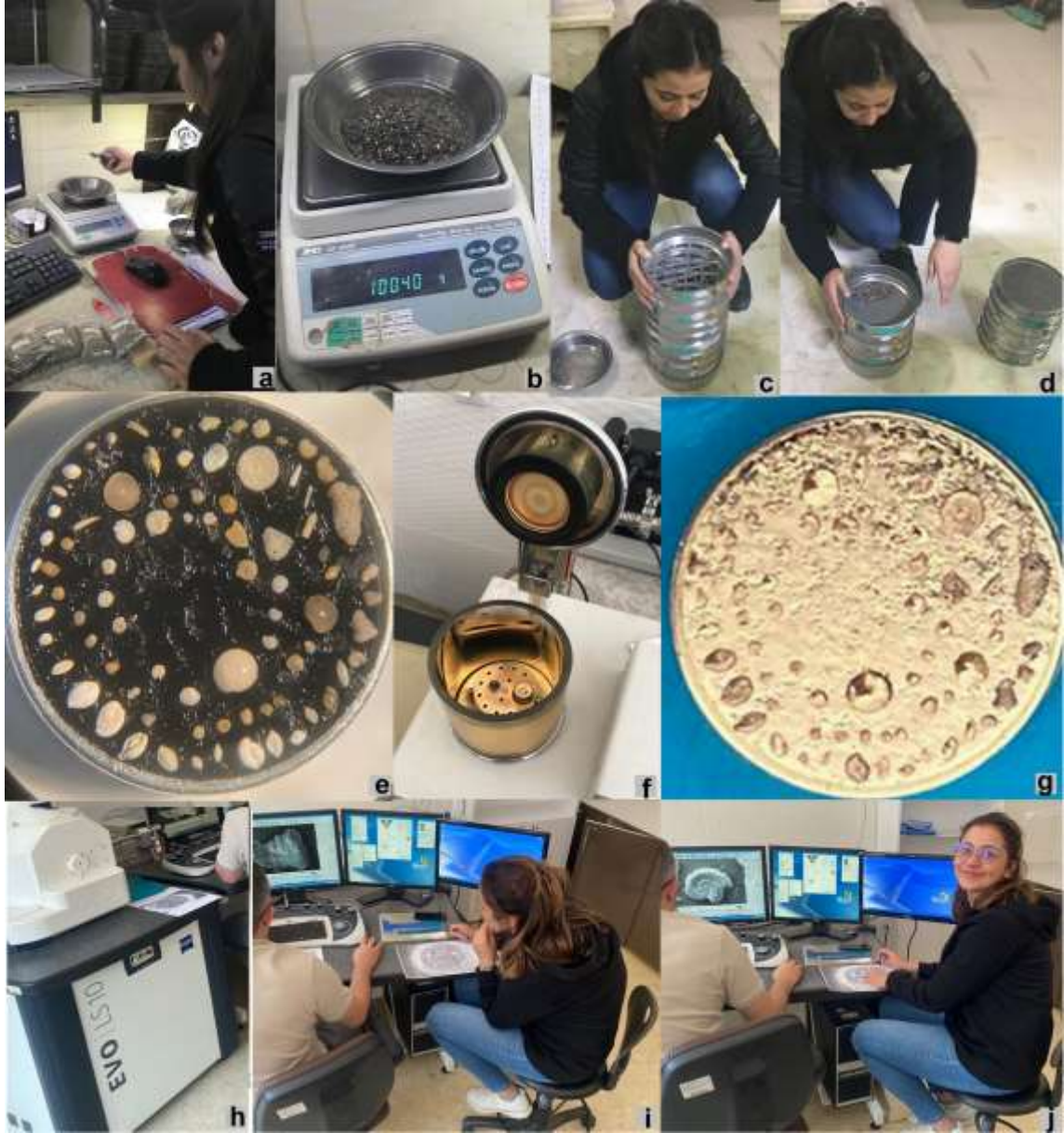
Şekil 2.3. a-d. Granülometri incelemeleri kapsamında sediment örneklerinin hazırlanması ve elenmesi işlemi e-j. Seçilen bentik ve planktik foraminifer numunelerinin SEM incelemeleri kapsamında altınla kaplanması ve görüntülenme işlemleri
