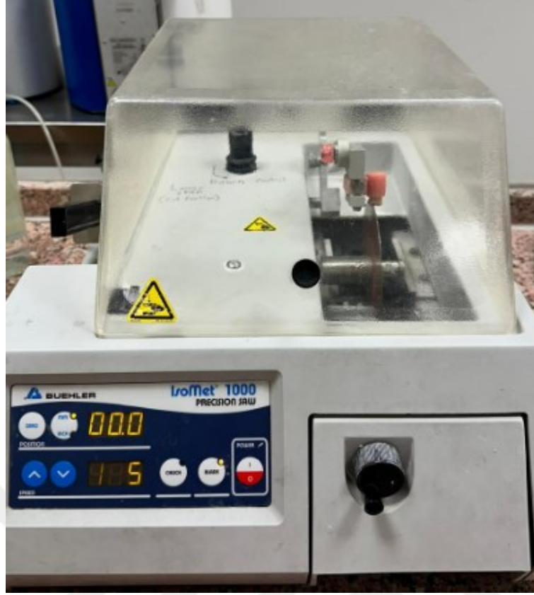
Resim 3.17: Kesme cihazıyla seramik-dentin çubuklarının oluşturulması
