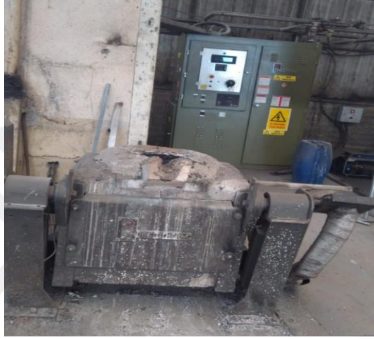
Şekil 4.2. İndüksiyon ertitme ocağı
