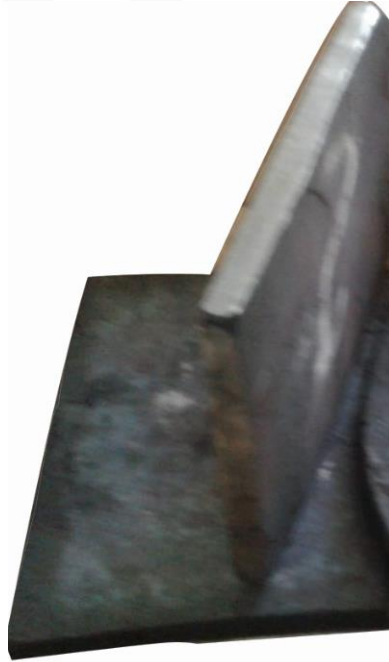
Şekil 4.6. Sıcak pres ile kalınlığı 16 mm'ye düşürülmüş plaka
