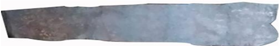
Şekil 4.9. Sıcak dövme ile imal edilen sac
