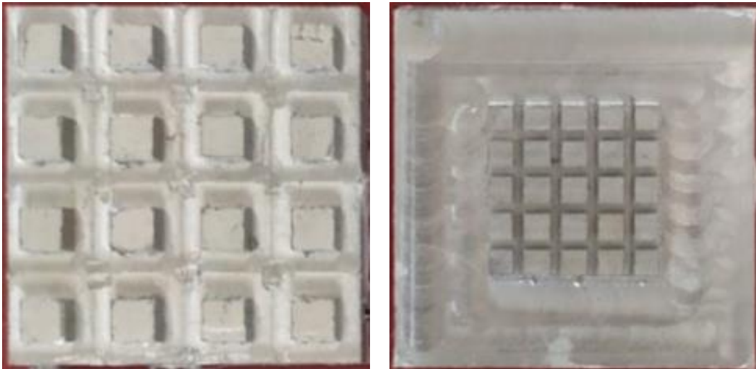
Şekil 56. En iyi sonuç veren kare-3 ve kare-26 ısı alıcılar.
