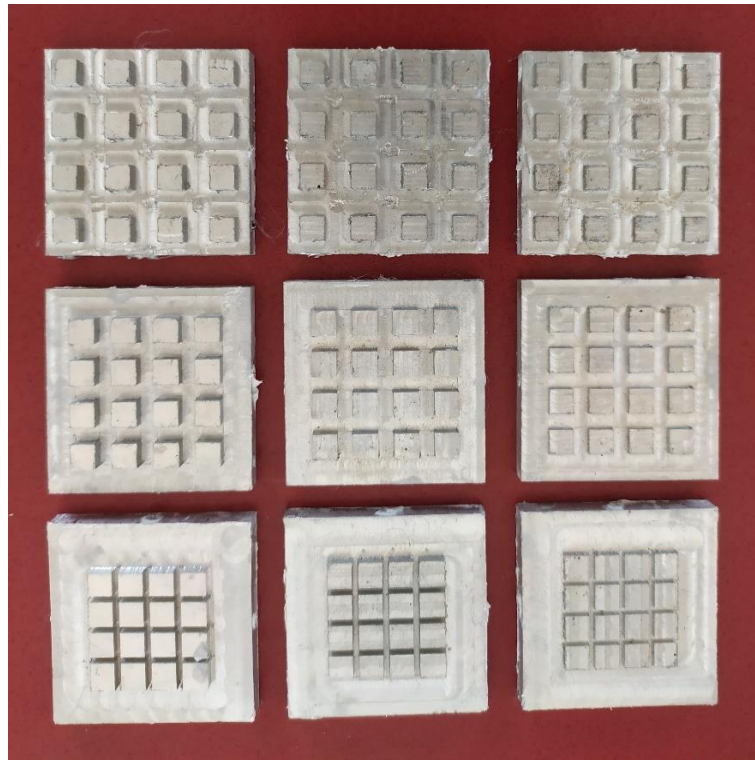
Şekil 52. Ön deney yapılan 5 mm kanat genişliğindeki ısı alıcılar.
