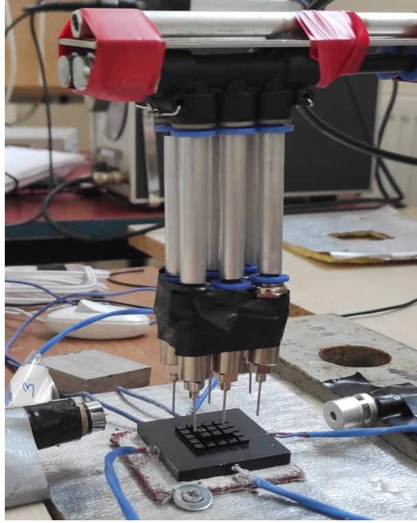
Şekil 67. 6 nozul ile yapılan 1, 1,5 ve 2 bar deneylerinin görünümü.
