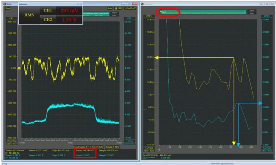
Şekil 76. Kare-26 dif-3 ısı alıcı, 5 nozul 2 bar için osiloskop ve spektrum analizör verileri.
