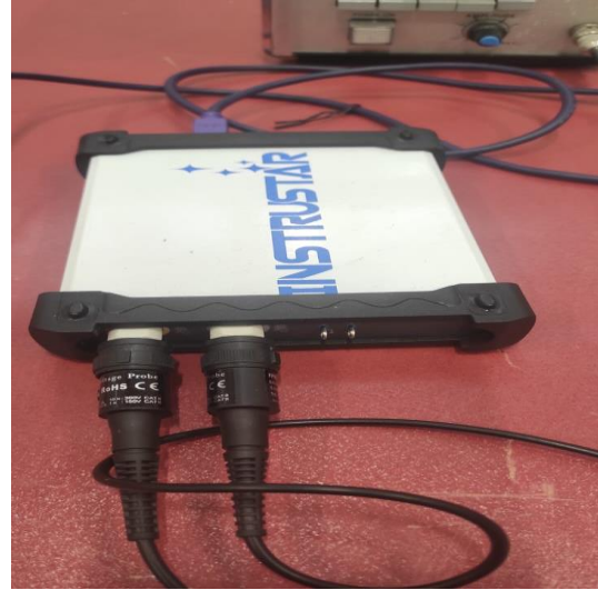
Şekil 62. Osiloskop ve spektrum analizörün, sinyal jeneratörü ile doğrulama deneyi görüntüsü.
