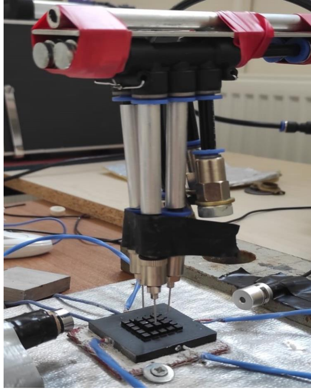
Şekil 88. 3 nozul ile yapılan 1, 1,5 ve 2 bar deneylerinin görünümü.
