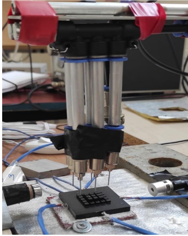
Şekil 74. 5 nozul ile yapılan 1, 1,5 ve 2 bar deneylerinin görünümü.
