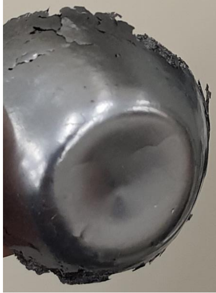
Şekil 4.2 : 950 °C’de bekletilerek uçucu maddesi uzaklaştırılmış numune.
