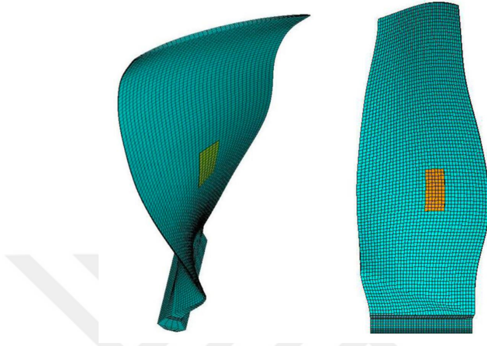
Şekil 3.4. Piezoelektrik yamaların fan kanatçığı yüzeyine montajı
