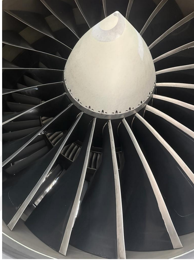
Şekil 3.2. Titanyum hücum kenarına sahip kompozit fan kanatçığı
