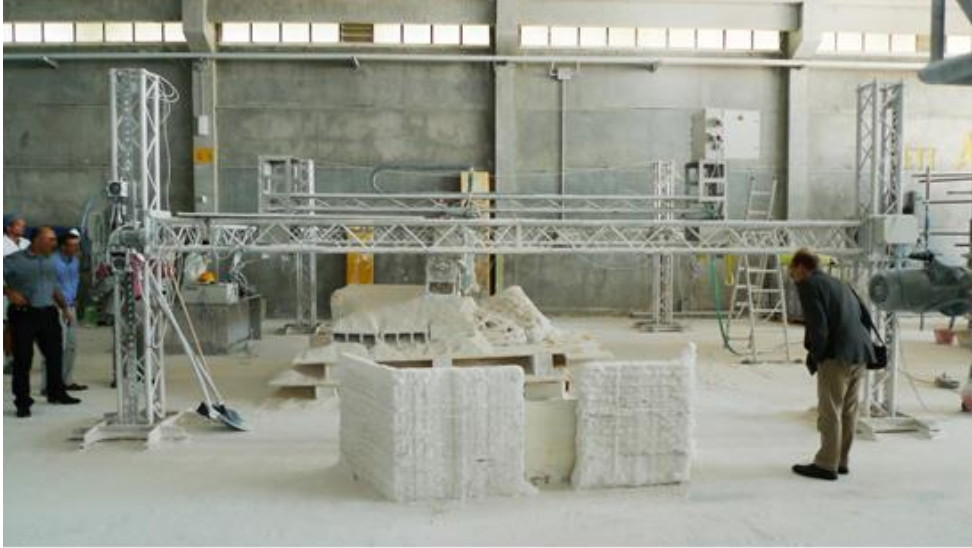
Şekil 4. 7. Ay Habitatu tasarımı için 3D baskı denemesi, 2013 (Url-30)
