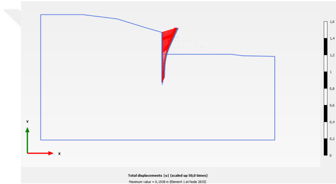
Şekil 3.83 H= 30 m Ø120 cm Teğet kazık yanal deplasmanlar.
