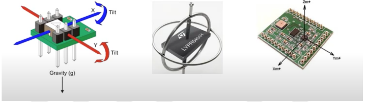
Şekil 12. IMU Sensörlerinin İçinde Bulunan Ivmeölçer, Jiroskop Ve Magnetometre.
