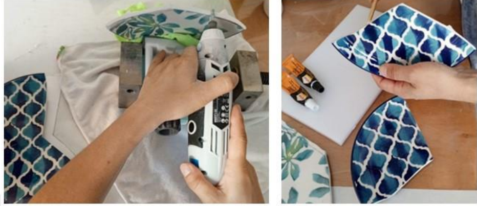
Görsel 73: Kırık kenarlara frezeleme işlemi yapılması-epoksi reçine sürülmesi
