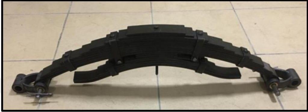
Şekil 1.1. Tasarlanan deneysel sistemde kullanılan yaprak yay sisteminin ana bileşenleri
