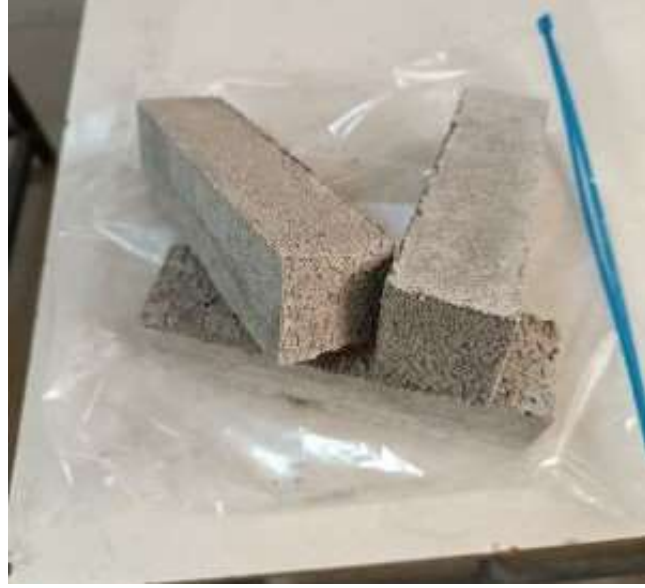
Şekil 3.20. Eğilme dayanımı testinden önce numunelerden bazıları
