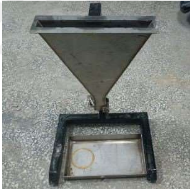
Şekil 3.14. Mini V hunisi deney aparatı
