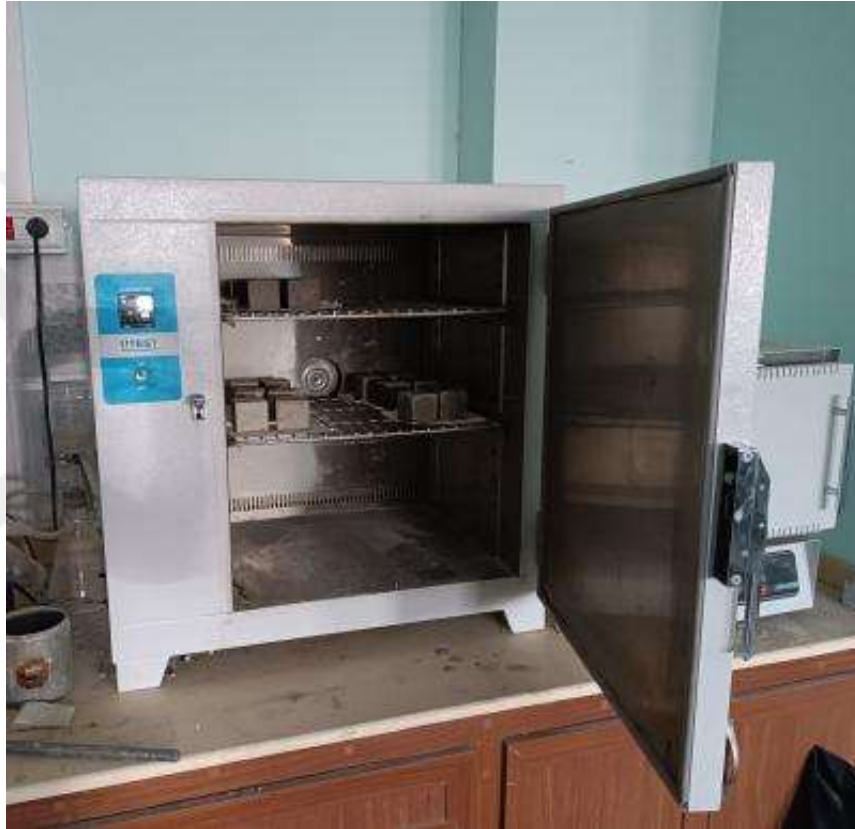
Şekil 3.22. Su emme deneyi için etüvde kurutulan numuneler
