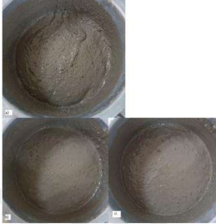
Şekil 3.7. Karıştırma aşamaları a) Toz malzemelere ile alkali çözelti eklenmiş durum b) Karışıma su eklenmiş durum c) Karışıma süper akışkanlaştırıcı katkı eklenmiş nihai durum
