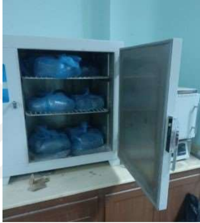
Şekil 3.11. Etüvde kürlenmeye bırakılan numuneler
