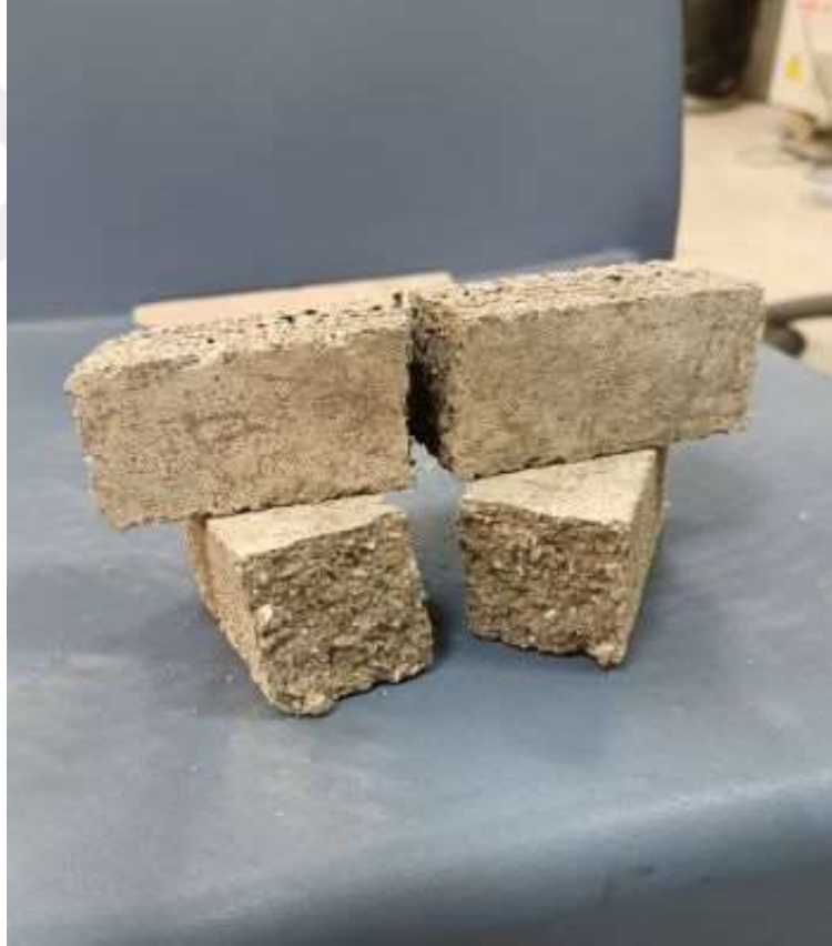
Şekil 3.21. Eğilme dayanımı testinden sonra kırılmış numunelerden bazıları
