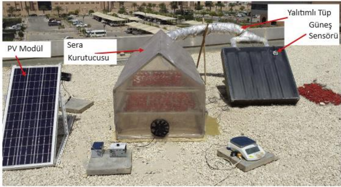
Resim 4.1. Sera kurutucusu ile entegre PV sistemi [19]
