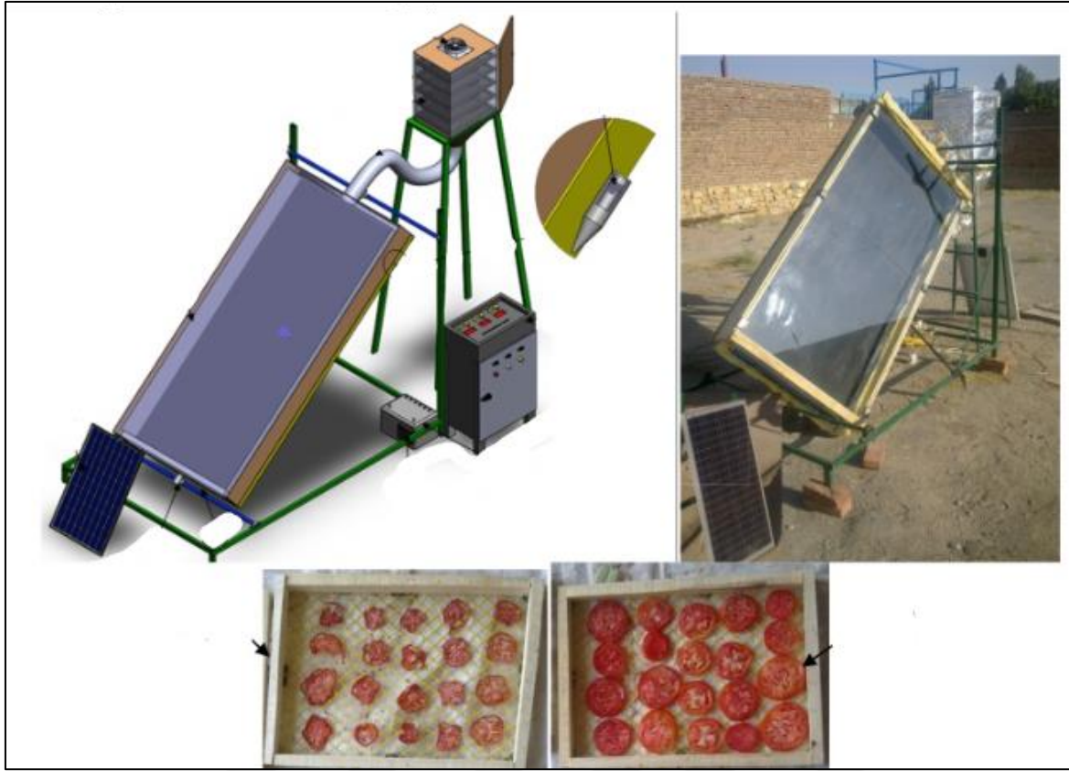
Resim 4.2. PV destekli bir güneş enerjisi kurutma sistemi [20]
