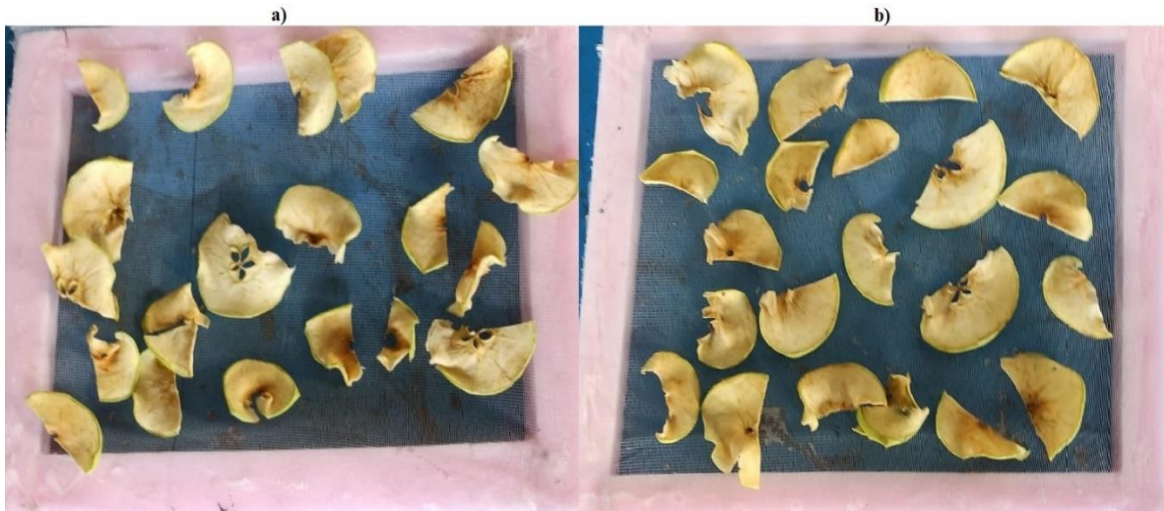
Resim 7.1. Kurutulmuş numunenin a) termal enerji depolamalı b) standart tip kurutucuda kurutulması sonrası fotoğrafları
