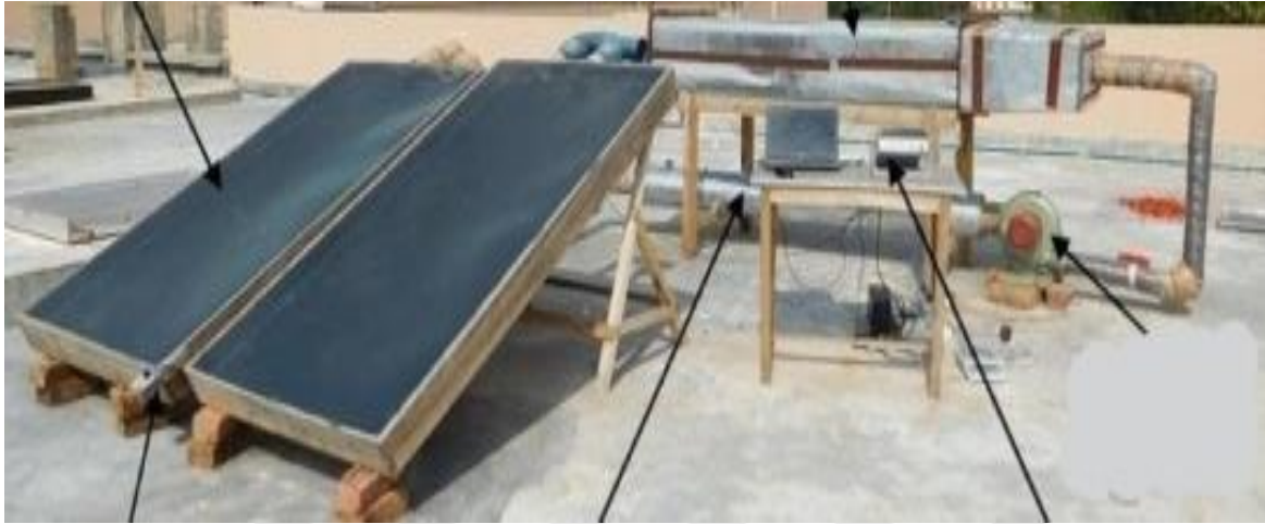
Resim 4.8. Gizli ısı depolamalı ve çift geçişli kurutucu [39]
