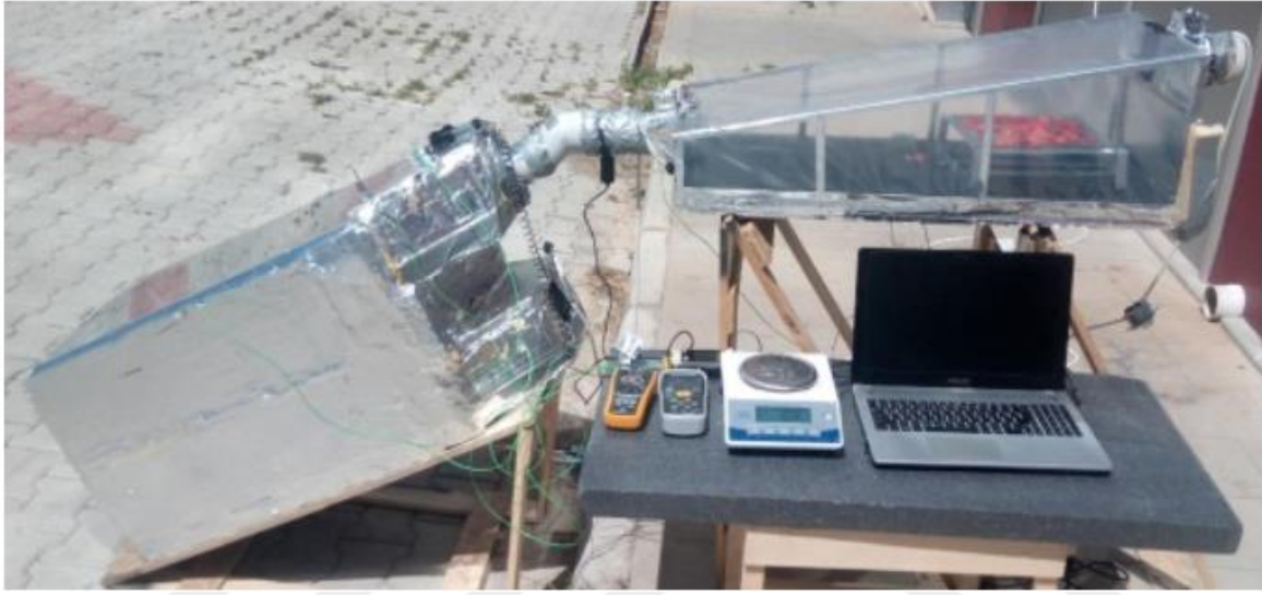
Resim 4.4. Dört geçişli güneş hava kolektörü [24]
