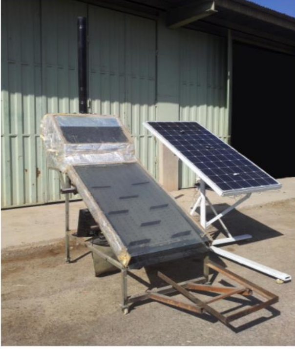
Resim 4.5. Kızılötesi destekli güneş enerjili kurutucu sistemi [25]
