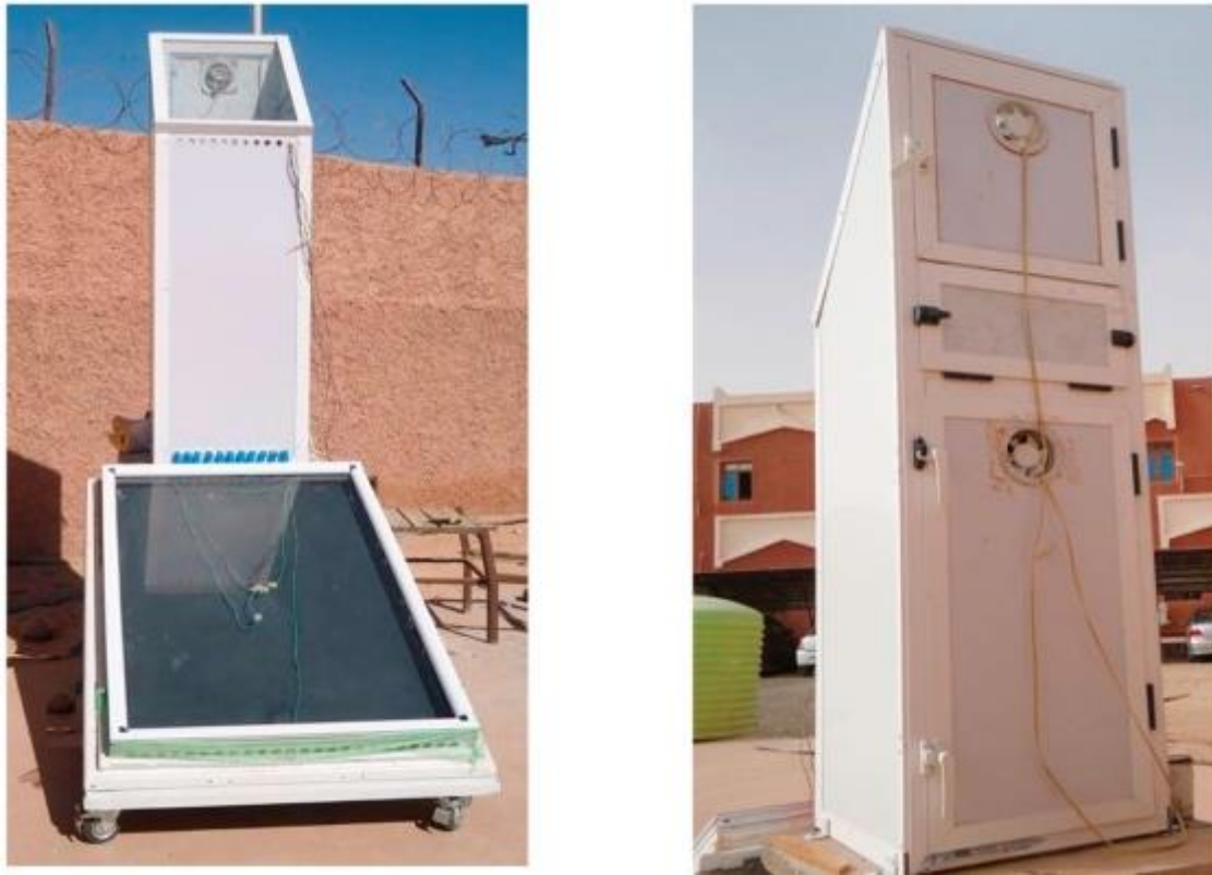
Resim 4.7. Isı depolamalı dolaylı konveksiyonlu bir güneş kurutucusu [38]
