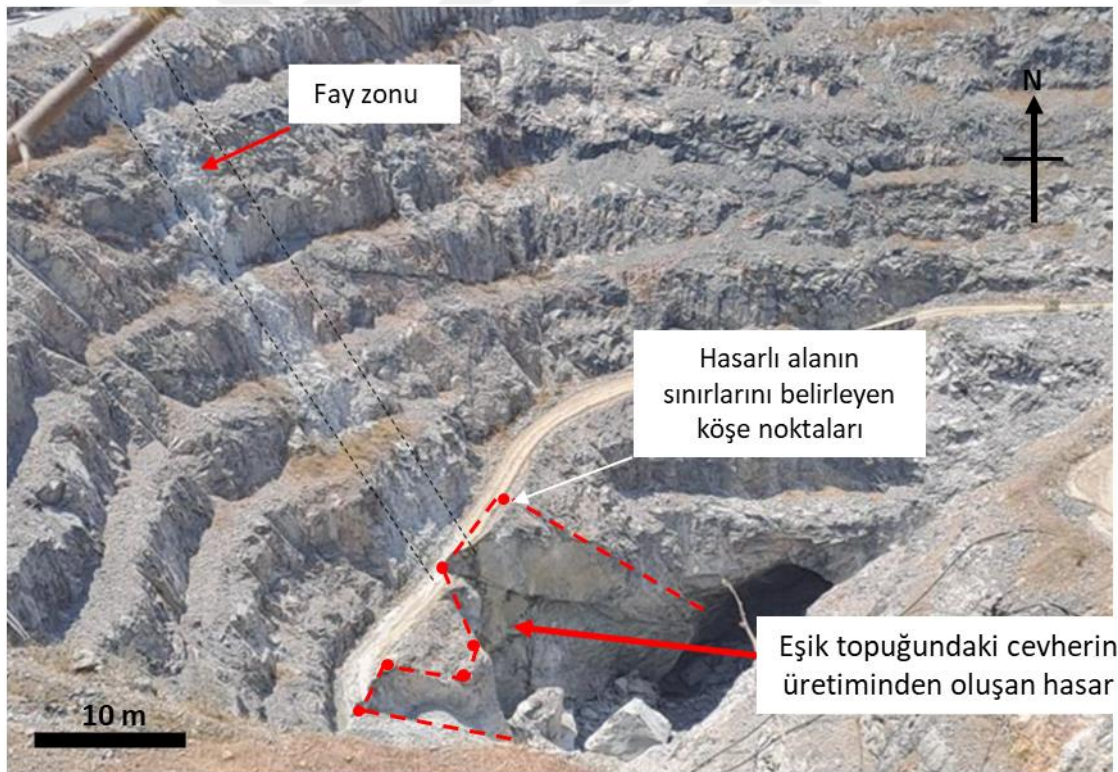
Şekil 5.29. CP'de yüksek tenörlü cevherin çıkarılmasından sonra sahada gözlemlenen deformasyon
