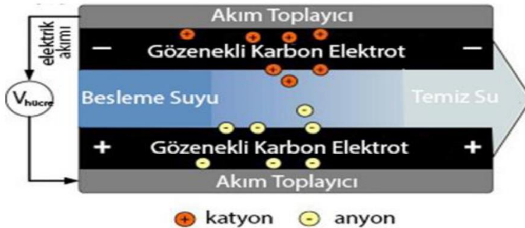
Şekil 3.3. Kapasitif deiyonizasyonun çalışma mekanizması [93].
