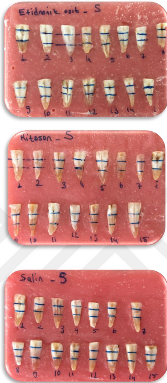
Resim 18. Mikrosertlik testi için 3 ayrı grup olarak hazırlanan bloklar
