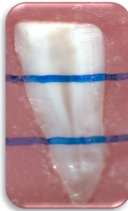
Resim 17. Üç ayrı bölgesinden ölçüm yapılmak üzere hazırlanan numune
