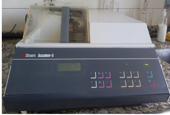
Resim 22. Örneklerden kesit almak için kullanılan hassas kesme cihazı
