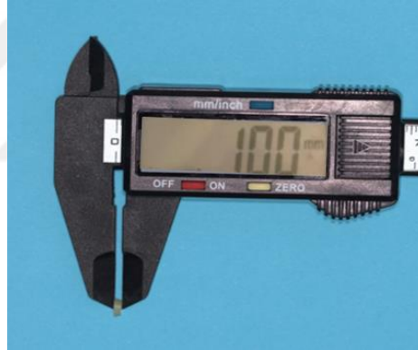
Resim 23. Dijital kumpas ile ölçülen numune kalınlıkları
