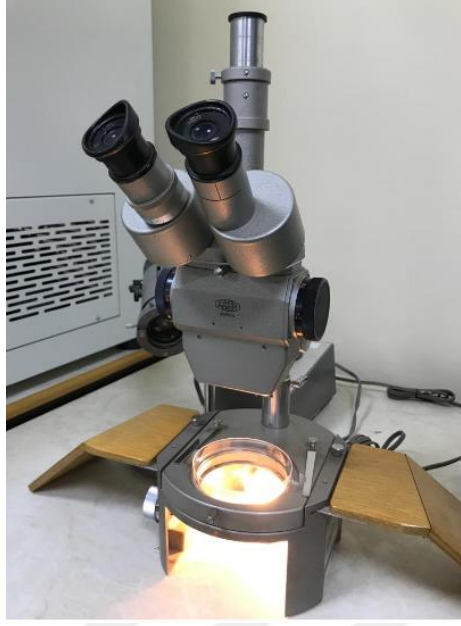
Resim 27. Kırık tipinin değerlendirilmesi için kullanılan stereomikroskop
