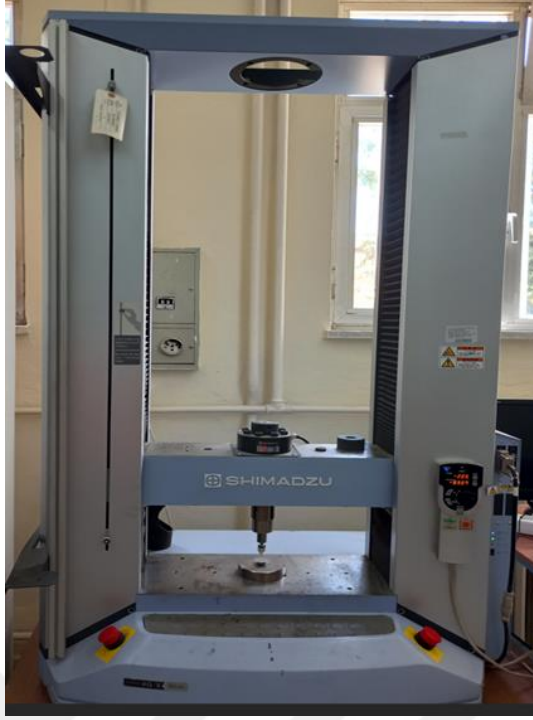
Resim 25. İtme bağlanma dayanımı testi için kullanılan universal test cihazı
