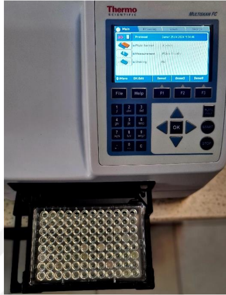
Şekil 3.3. Spektrofotometrede ölçüm işlemlerinin yapılması
