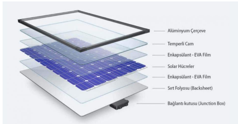
Şekil 2.2. FV panel ve bileşenleri (Svarc, 2020, s. 1)
