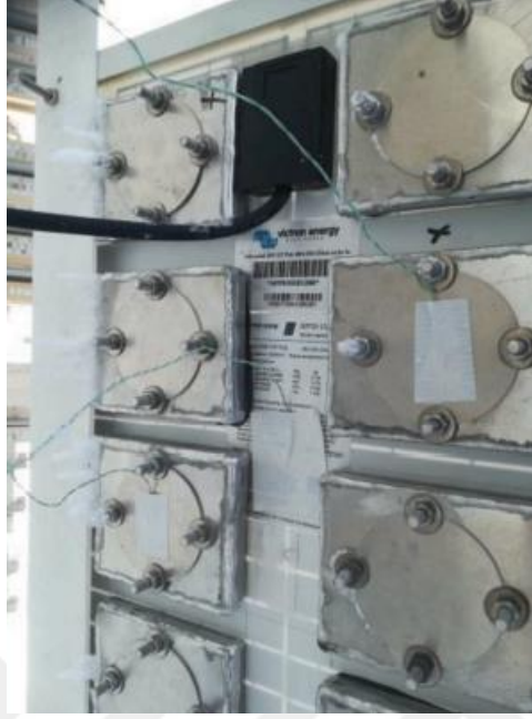
Şekil 2.14. FV panellerde FDM ile soğutma yöntemi uygulaması (Nizetic vd, 2021, s. 4).
