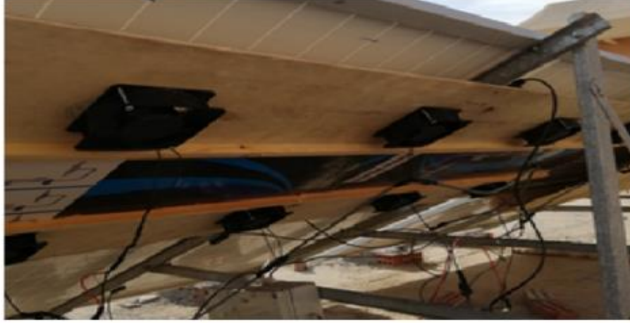
Şekil 2.13. FV panellerde fan ile aktif soğutma yöntemi uygulaması (Hussien vd, 2022, s. 5)
