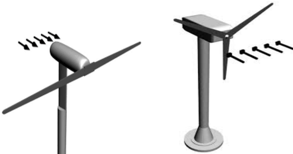
Şekil 2.11 Rüzgarı arkadan alan ve rüzgarı önden alan rüzgar türbinleri [38].
