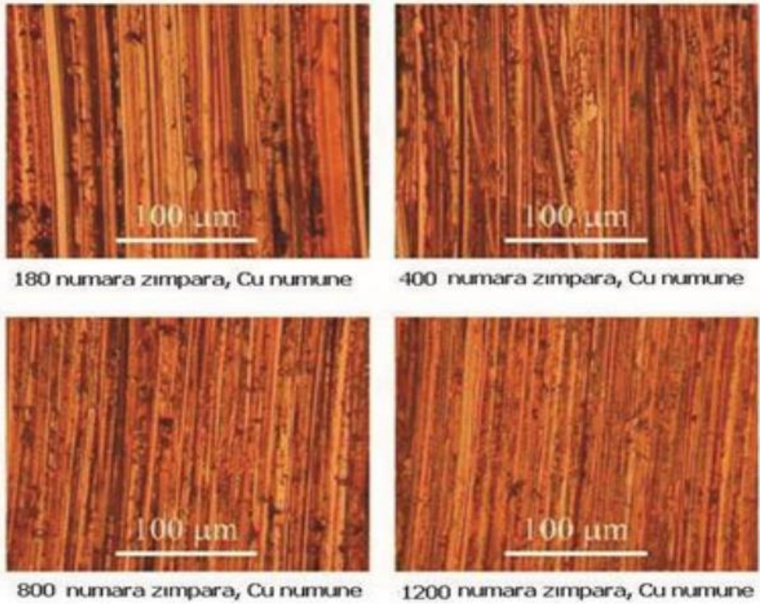
Şekil 3.12. Cu numunesi ile doğru yapılmış zımparalama işlemi [21].
