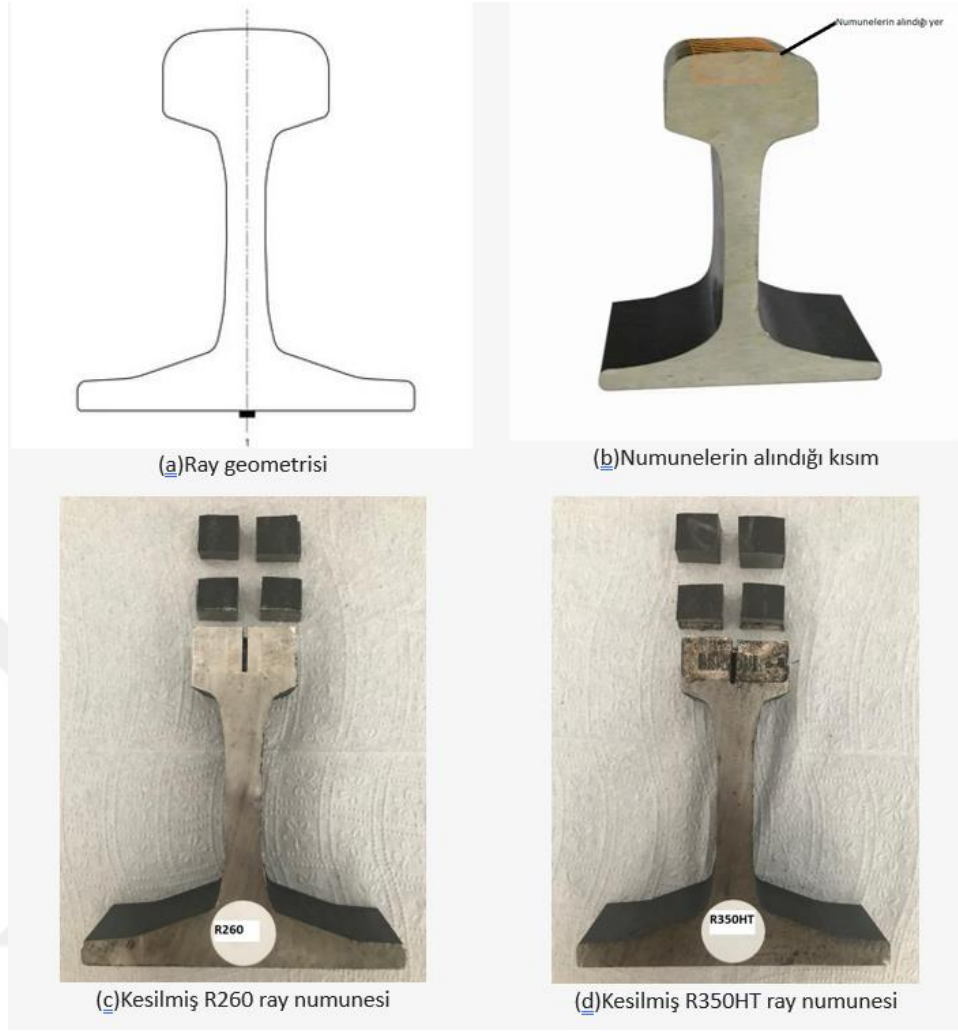
Şekil 5 1. (a) Ray geometrisi. (b) Numunelerin alındığı kısım. (c) Kesilmiş R260 ray numunesi. (d) Kesilmiş R350HT ray numunesi
