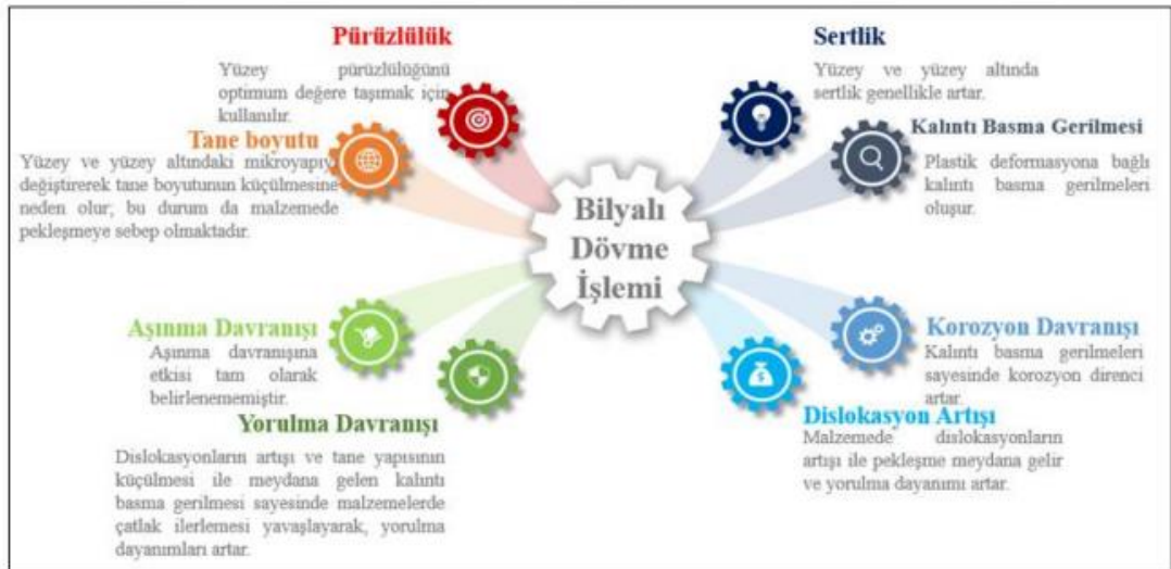
Şekil 4.2. Bilyalı dövme sonrası değişen özellikler [27].
