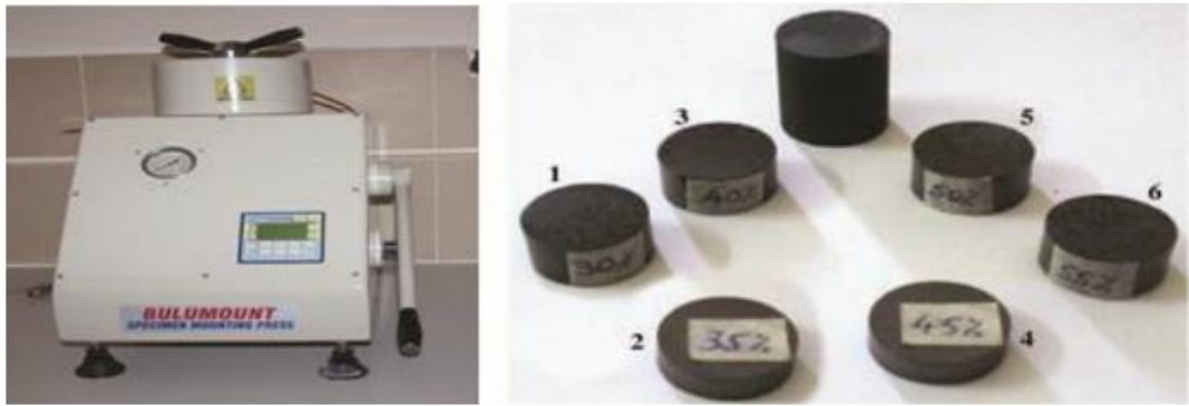
Şekil 3.9. Bakalite alma cihazı ve bakalite alınmış numuneler [21].
