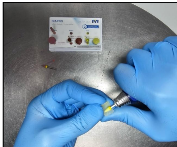
Şekil 2.8. Polisaj gruplarındaki örneklerin universal lityum disilikat polisaj seti ile polisajlarının yapılması
