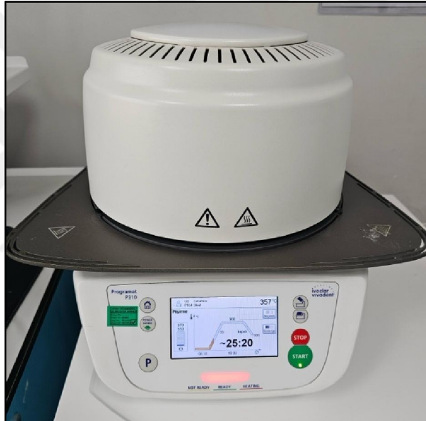
Şekil 2.6. Kristalizasyon işlemi için örneklerin fırınlanması
