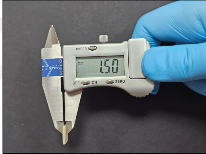
Şekil 2.5. Dijital kumpas ile örnek kalınlıklarının ölçümü ve kontrolünün yapılması
