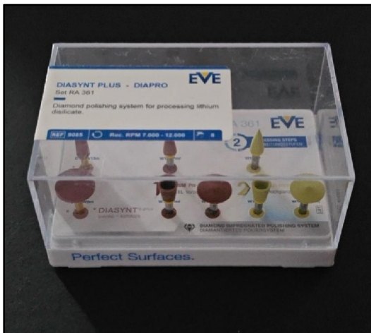
Şekil 2.8. Polisaj gruplarındaki örneklerin universal lityum disilikat polisaj seti ile polisajlarının yapılması
