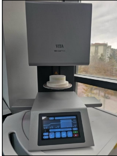
Şekil 2.10. Glaze için fırınlama işleminin yapılması
