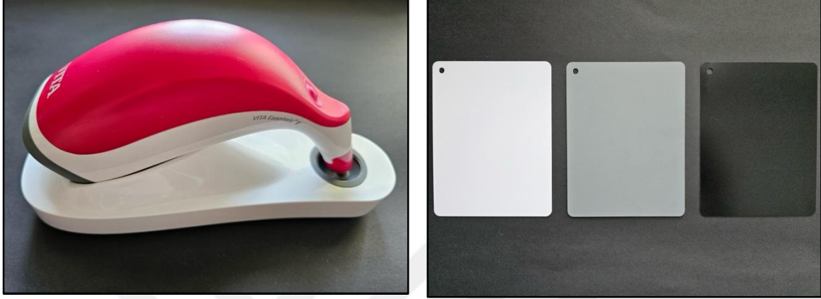
Şekil 2.11. Dental spektrofotometre ve kullanılan beyaz, gri ve siyah arka planlar
