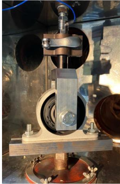
Şekil 3.1 Dinamik katılık verilerinin kaydedildiği test sistemi
