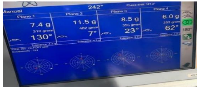
Şekil 5.5 Balanssızlık ölçüm sonucu örneği
