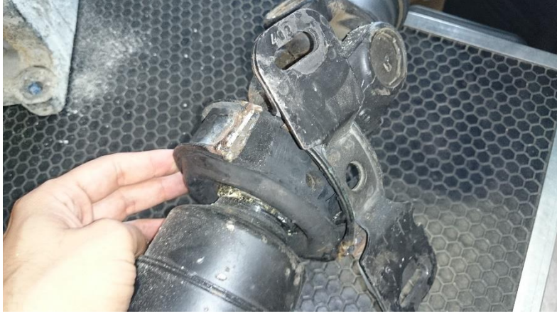
Şekil 6.1 Kardan şaftı askısına ait kırılma hatası
