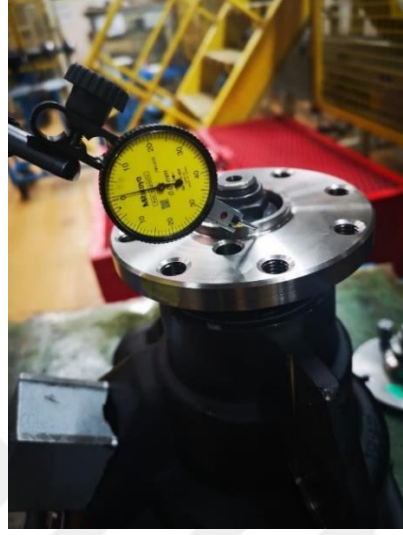
Şekil 4.5 Arka aks flanşı pilotlama çapında gerçekleştirilen salgı kontrolü
