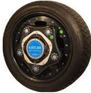
Şekil 5.3 Teker merkezinden ölçüm alınan sensör örneği
