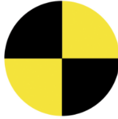
Şekil 5.6 Açısal konum kontrolü amacıyla kullanılan etiket
