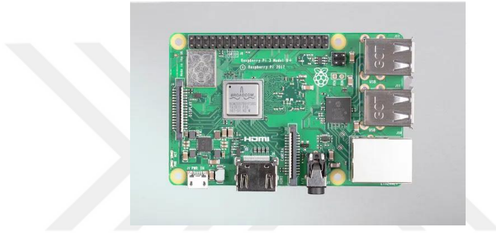
Şekil 3.3. Raspberry Pi 3 B+ Model Tek Kart Bilgisayar [38]
