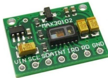
Şekil 3.13. Max30102 Nabız ve Kandaki Oksijen Görüntüle Modülü [47]
